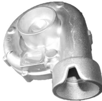
Obrázek 5.27 Zavalenina a problém s odvzdušněním
