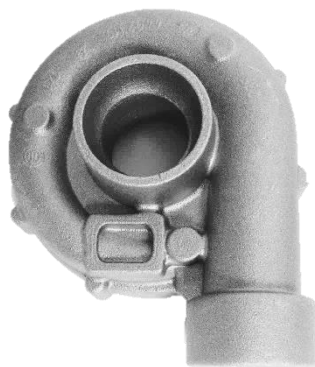
Obrázek 5.29 Odlití bez zavalenin a předčasně ztuhlé taveniny
