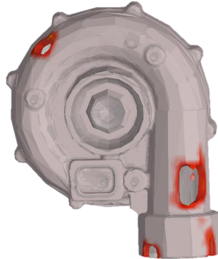
Obrázek 5.53 Tuhá fáze pro T=700^{\circ}\text{C}
