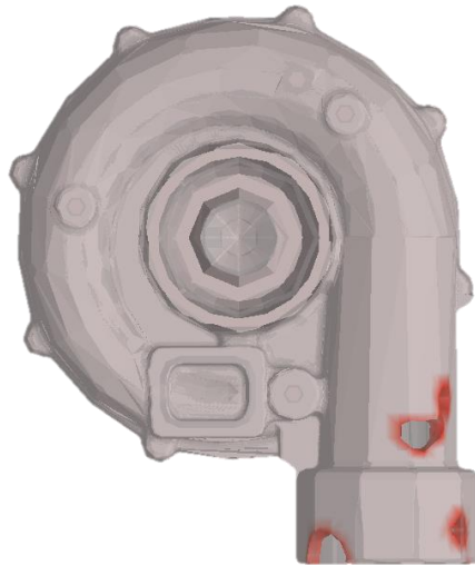
Obrázek 5.52 Tuhá fáze pro T=730^{\circ}\text{C}
