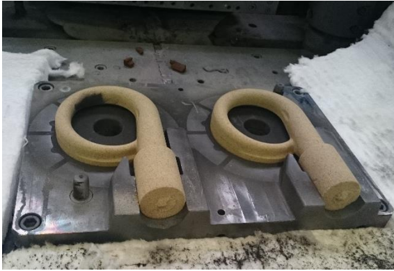
Obrázek 5.19 Založení jader do formy
