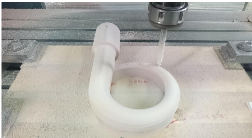
Obrázek 5.1 Obrábění makety jádra
