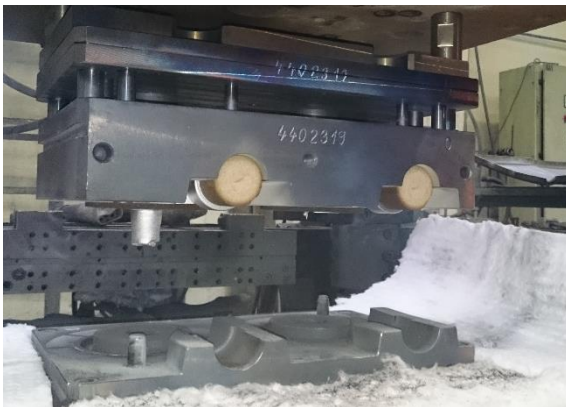
Obrázek 5.19 Založení jader do formy
