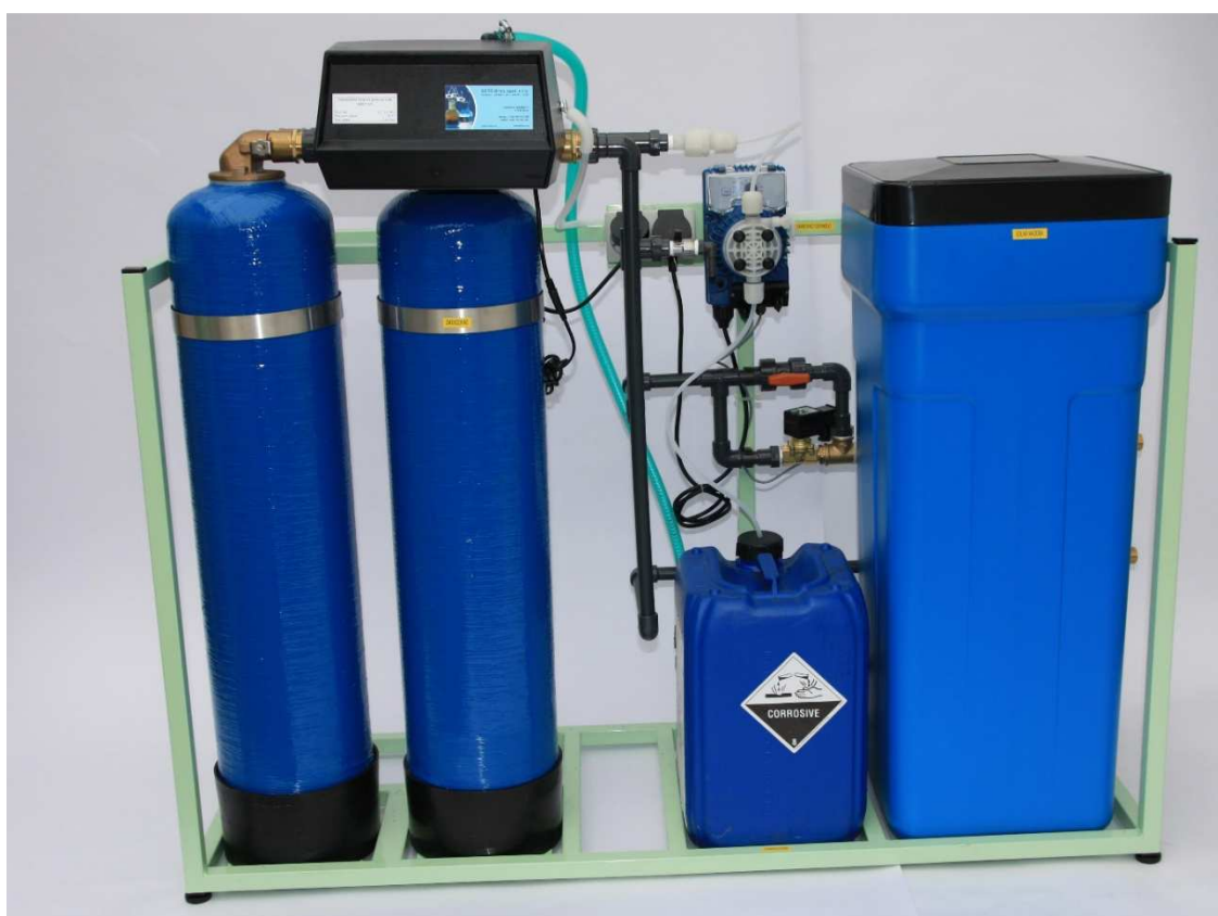
Obr. 2 Změkčovací stanice napájecí vody, dva regenerační filtry, zásobník solanky a dávkovací čerpadlo [8]
