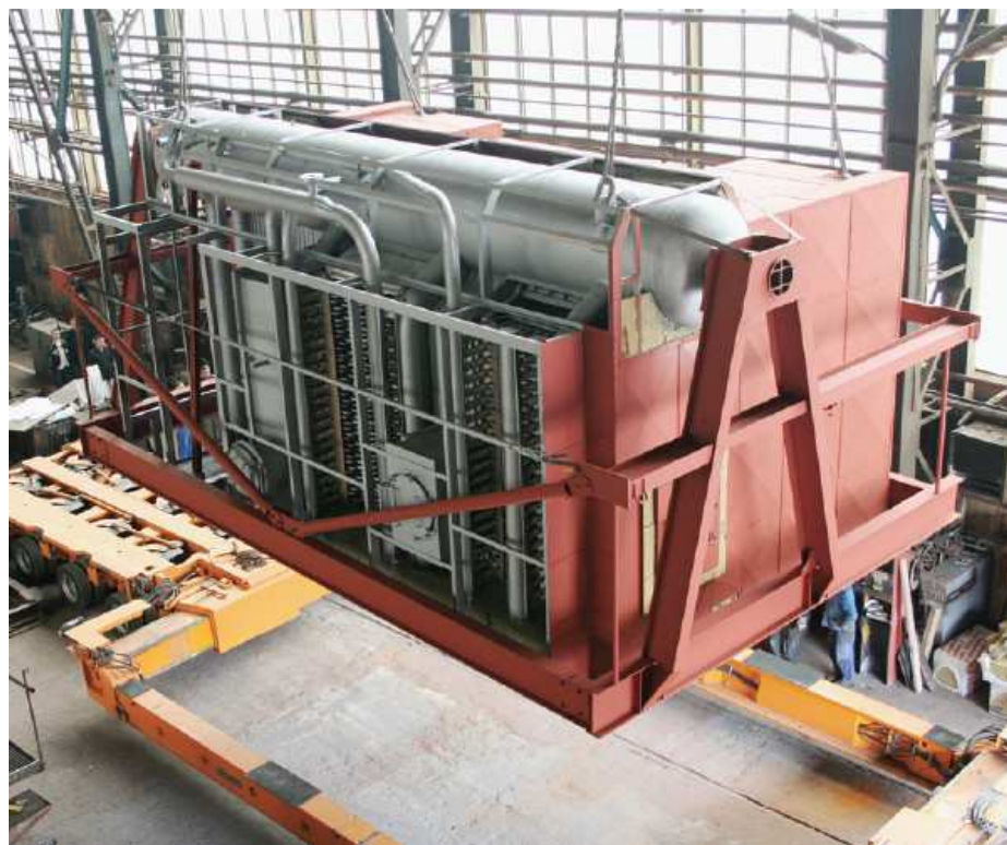
Obr. 11 Vodotrubný kotel na přehřátou páru s přirozenou cirkulací. Typ OKP, výrobce DUKLA STROJÍRNY [19]
