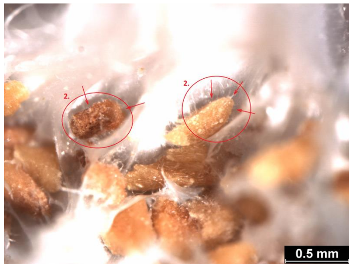
Obr. 43: Snímek lomové plochy kompozitu s drcenými ořechovými skořápkami a matricí v základním stavu
