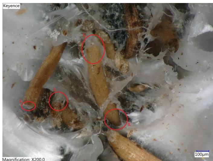
Obr. 60: Snímek lomové plochy kompozitu s kokosovými vlákny a matricí s plazmovou modifikací pomocí vzduchu
