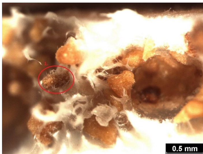
Obr. 41: Snímek lomové plochy kompozitu s drcenými ořechovými skořápkami a matricí s plazmovou modifikací pomocí kyslíku
