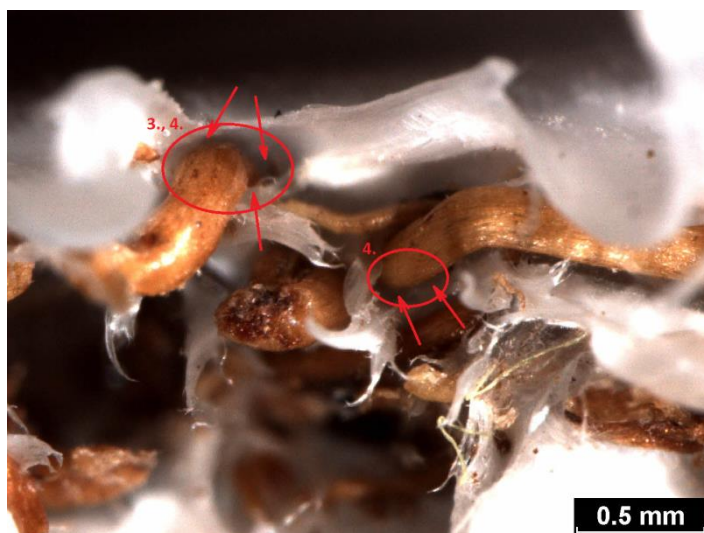
Obr. 40: Snímek lomové plochy kompozitu s kokosovými vlákny a matricí v základním stavu
