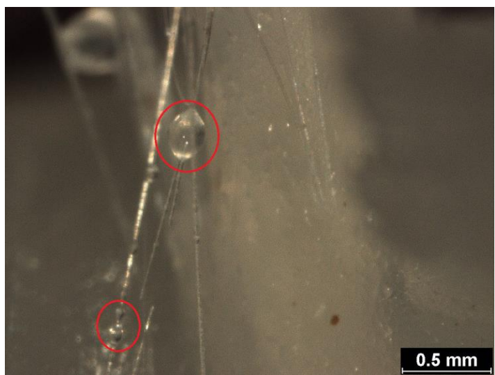
Obr. 51: Snímek skleněných vláken a ulpělých kapek matrice v plazmově modifikovaném stavu pomocí vzduchu
