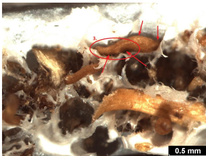
Obr. 39: Snímek lomové plochy kompozitu s kokosovými vlákny a matricí s plazmovou modifikací pomocí vzduchu
