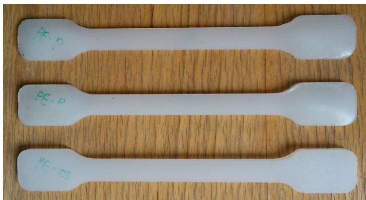
Obr. 24: První vzorky bez plniva (vrchní vzorky PE plazmou modifikované, spodní vzorek PE v základním stavu)
