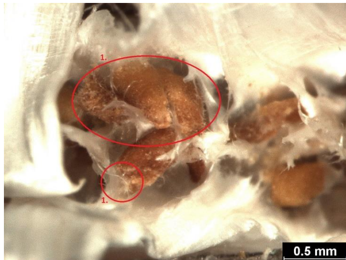
Obr. 42: Snímek lomové plochy kompozitu s drcenými ořechovými skořápkami a matricí s plazmovou modifikací pomocí vzduchu
