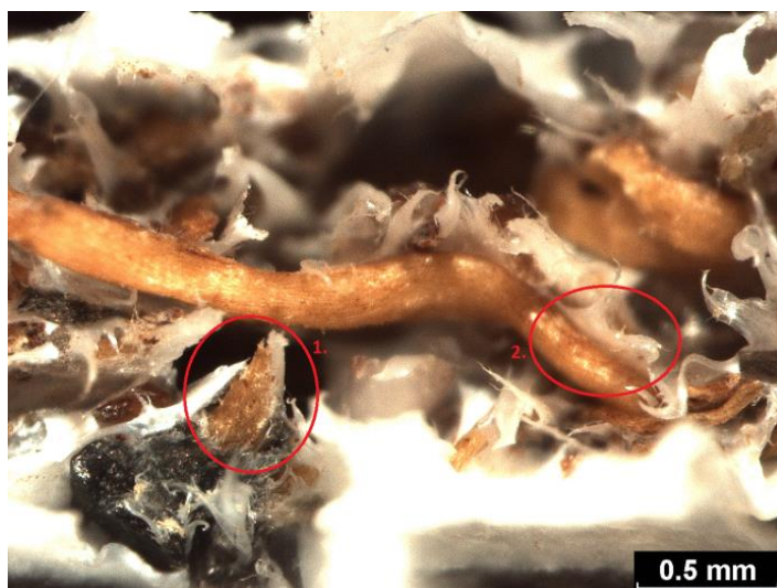
Obr. 38: Snímek lomové plochy kompozitu s kokosovými vlákny a matricí s plazmovou modifikací pomocí kyslíku
