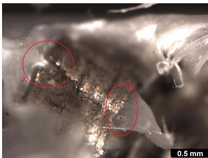
Obr. 47: Snímek lomové plochy kompozitu s ocelovými třískami a matricí s plazmovou modifikací pomocí vzduchu
