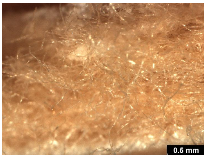
Obr. 44: Snímek lomové plochy kompozitu s bavlněnými vlákny a matricí s plazmovou modifikací pomocí kyslíku
