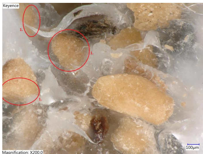
Obr. 61: Snímek lomové plochy kompozitu s drcenými ořechovými skořápkami a matricí v základním stavu
