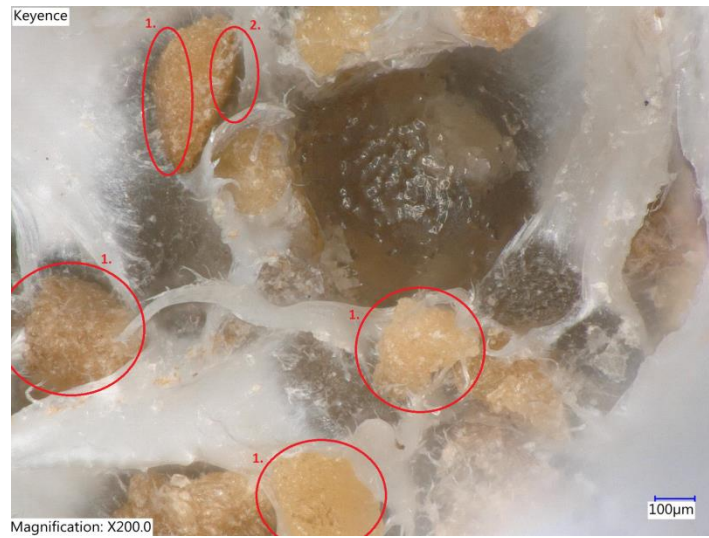
Obr. 62: Snímek lomové plochy kompozitu s drcenými ořechovými skořápkami a matricí s plazmovou úpravou pomocí vzduchu
