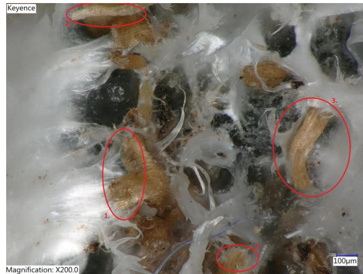
Obr. 59: Snímek lomové plochy kompozitu s kokosovými vlákny a matricí v základním stavu
