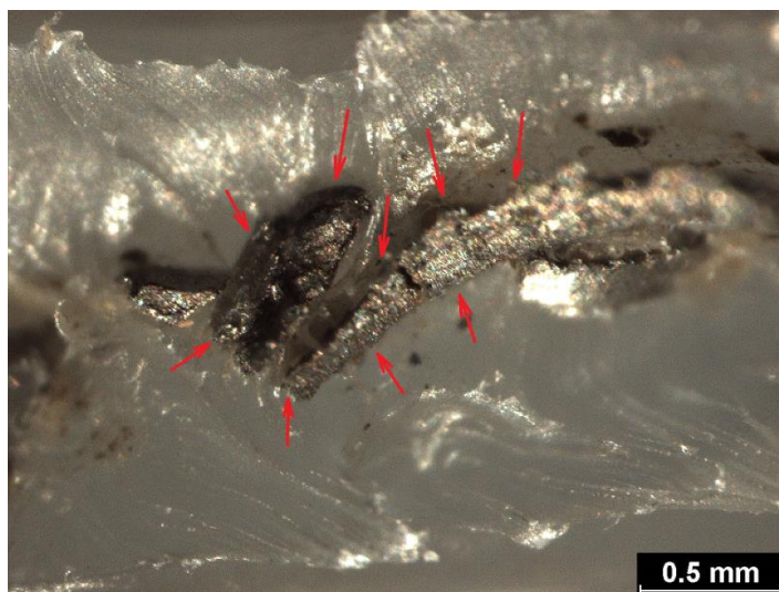
Obr. 49: Snímek lomové plochy kompozitu s ocelovými třískami a mikrotenovou matricí
