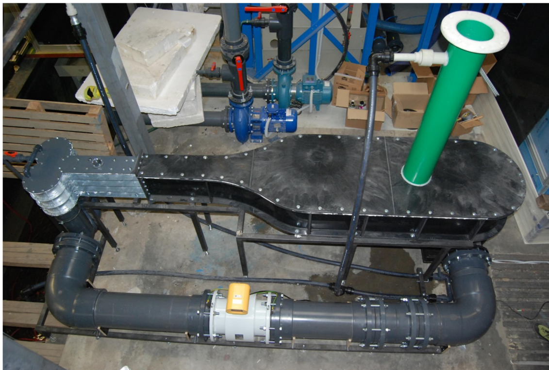
Obr. 24 – Vodní cirkulační trať v prostorech laboratoře Ústavu mechaniky tekutin a termodynamiky
