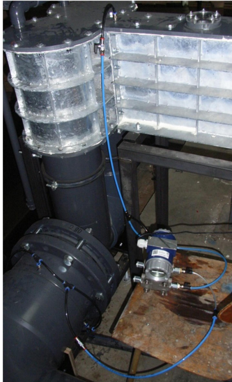
Obr. 28 - Uspořádání při měření rozdílu statických tlaků před a za spirálním difuzorem
