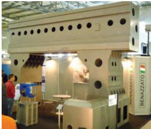
Obr. 9: Svařovaná nosná struktura portálu firmy Benazzato, [2]
