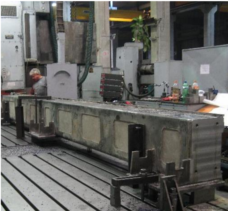
Obr. 18: Lože s betonovou výplní, [9]
