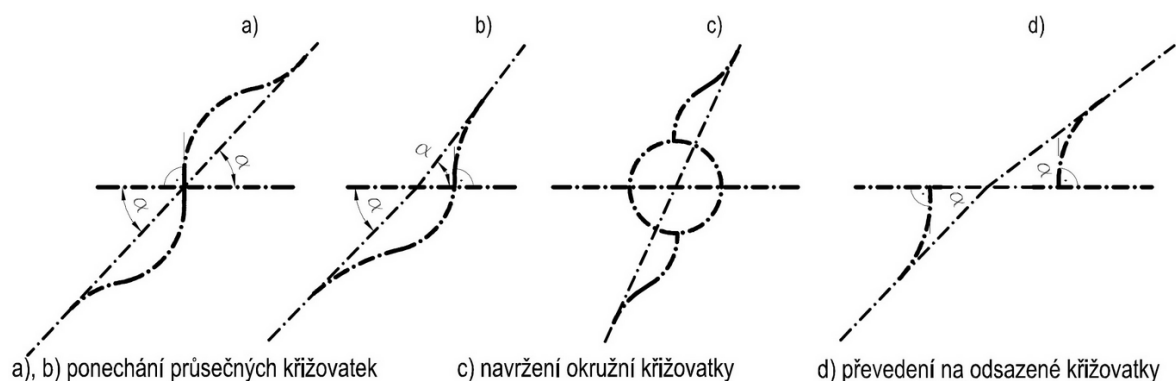
Obrázek 26: Návrhy úprav při nevhodném úhlu křížení
