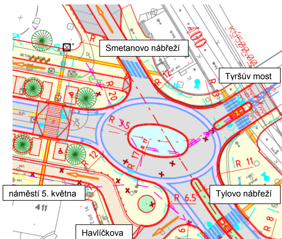
Obrázek 19: Ukázka dopravního řešení křižovatky U Tyršova mostu od Transconsult s.r.o.
