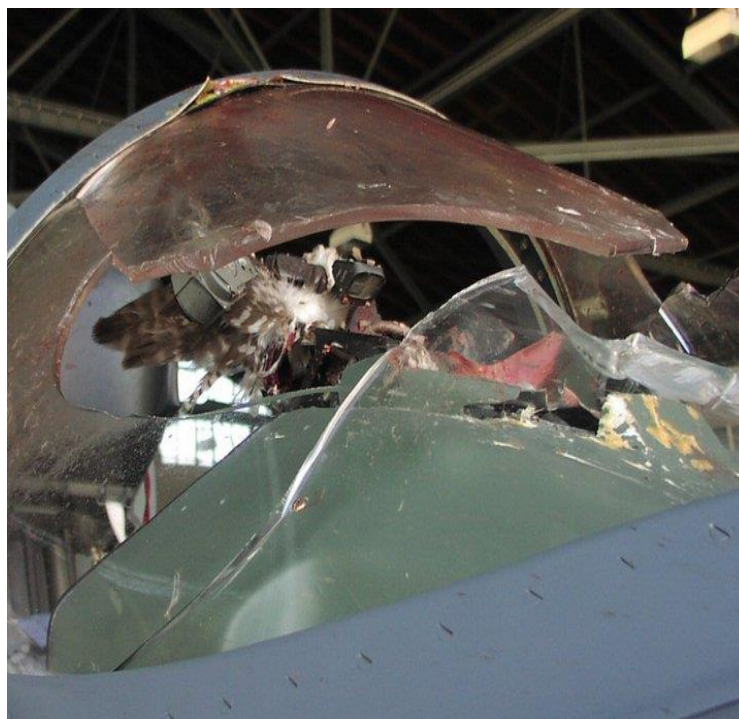
Poškozené čelní sklo L-39 po střetu s kání lesní – Pardubice (Gallatová, 2008)
