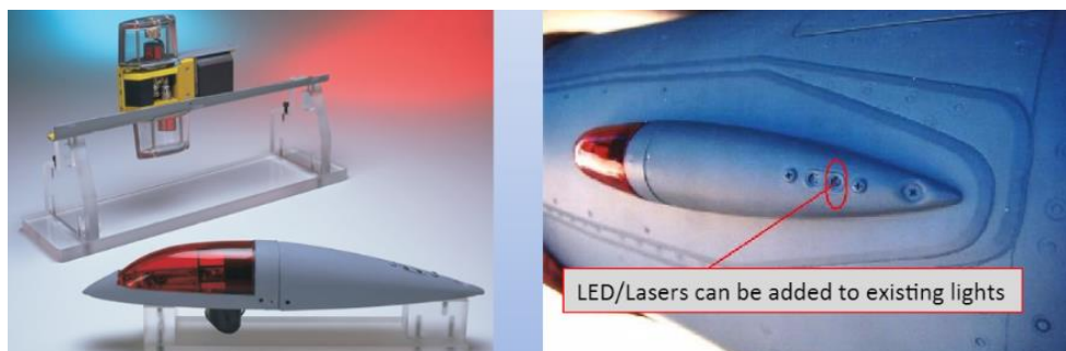
Obr. 4. Možnost umístění přídavných LED světel (Barnes a Dolbeer, 2015)
