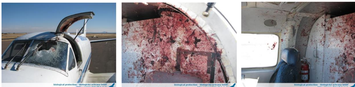
Poškozené čelní sklo a zatřísněná kabina (Gallat)
