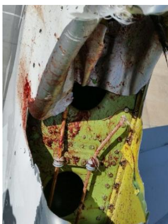
19. března 2016, Kulula Airlines, střet s husicí egyptskou, poškozená SOP ( http://avherald.com/ )
