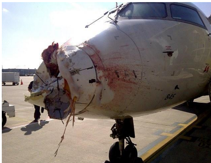
Malé dopravní letadlo, poškození způsobené střetem s čápem (Gallat, 2011)
