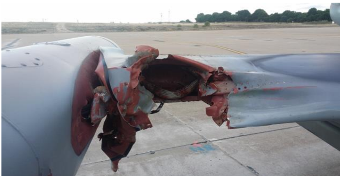
Obr.1. Závažně poškozené křídlo L-159 po střetu se supem (Armádní noviny, 2015)
