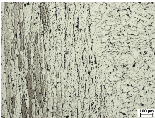
Obr. 32 Přechod ze ZM do svarového kovu – hrana natavení
