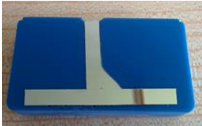
Obr. 27 Bruska a leštička Buehler Obr. 28 Vzorek po vyleštění
