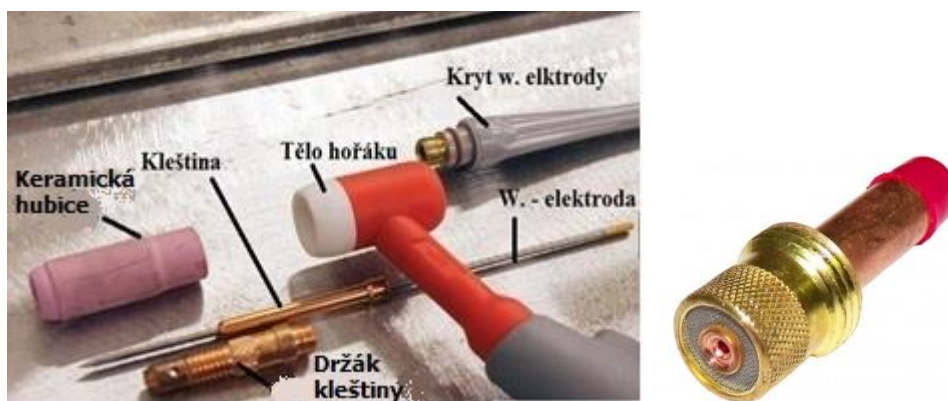
Obr. 13 – Svařovací hubice a plynová čočka – AUTOR NEUVEDEN, www.techpark.sk [online]. [cit. 18. 6. 2015]. Dostupný na: http://www.techpark.sk/technika-9102014/air-liquide-welding-reseni-pro-automatizaci-ve-svarovani.html
