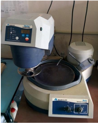
Obr. 27 Bruska a leštička Buehler Obr. 28 Vzorek po vyleštění
