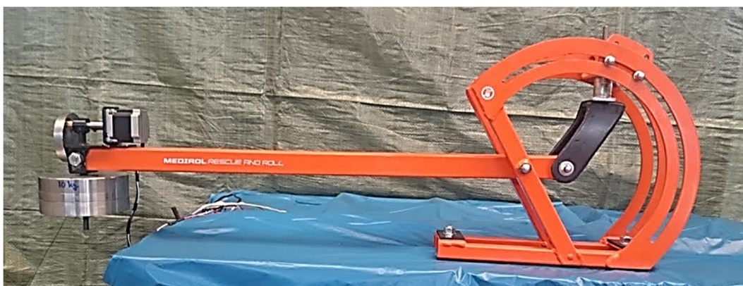
Obr. 56.: Pohled na sestavu pro testování kompozitní vidlice
