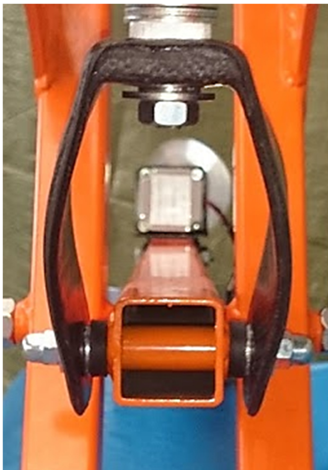
Obr. 57.: Deformace vidlice upnuté v testovacím standu při zatížení
