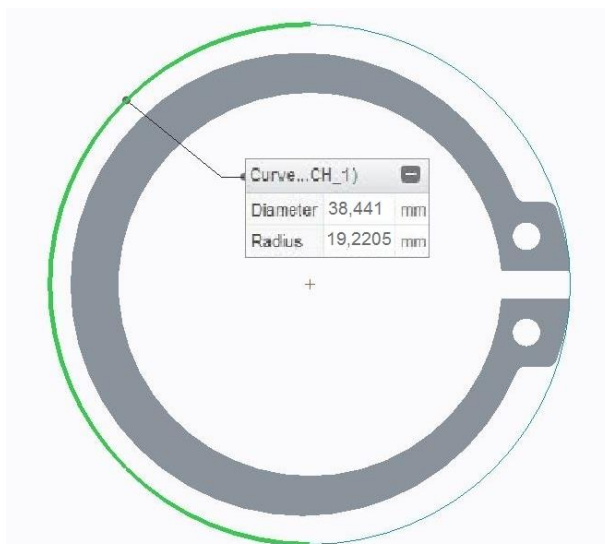
Obr. 48 Kolidující rozměr (kružnice pojistného kroužku - zeleně)
