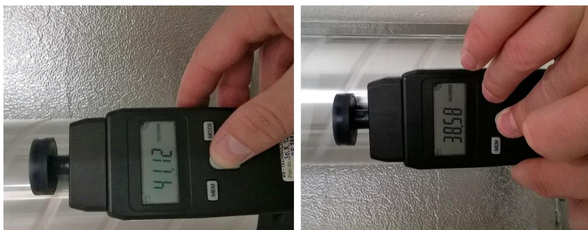
Obr. 22 Pohled na měřící zařízení Testo 470 při měření
