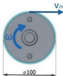
Obr. 28 přepočítání obvodové rychlosti na otáčky
