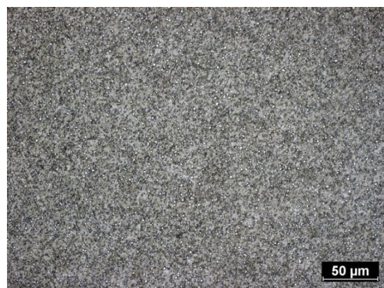
obr. 7 Příklad struktury NO vyráběné technologií práškové metalurgie.
