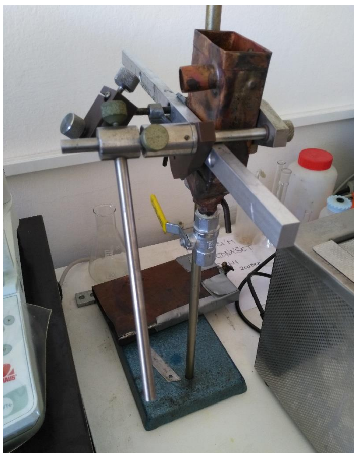
obr. 25 - Nádrž s vypouštěcím ventilem pro vypouštěcí zkoušku
