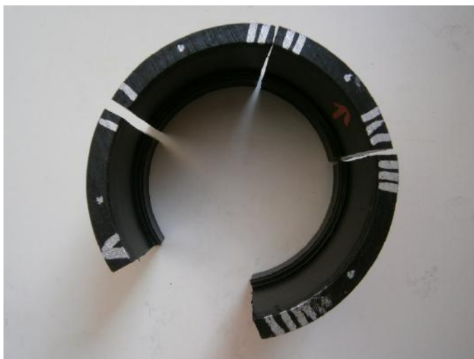
Obr. 6.1 Měřený svar potrubí 160x9,1 PE100
