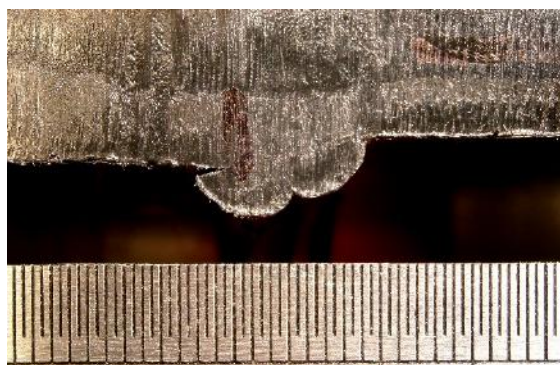
Obr. 7.8 Tvar přesazeného spoje
