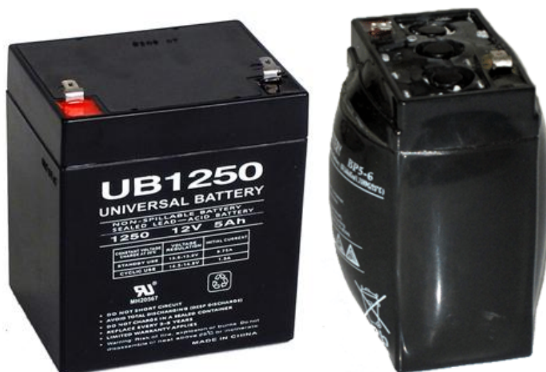
Obr. 7 – Ukázka nového a poškozeného SLA akumulátoru [18], [19]
