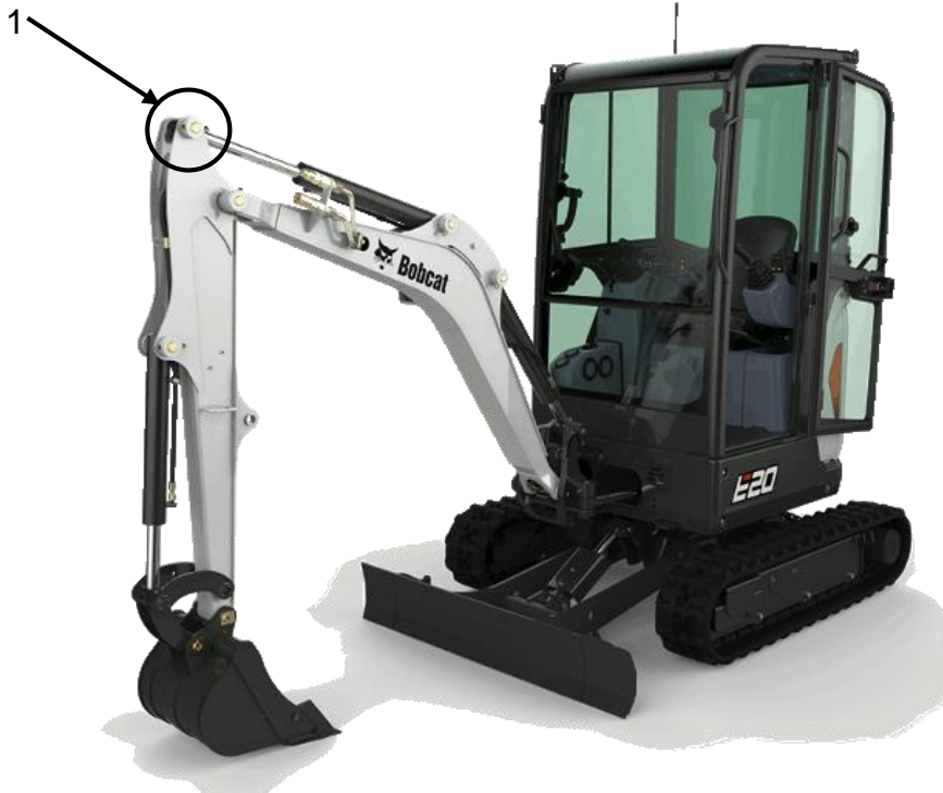
Obr. 33: Zátěžový test v provozu – spojovací čep - umístění
