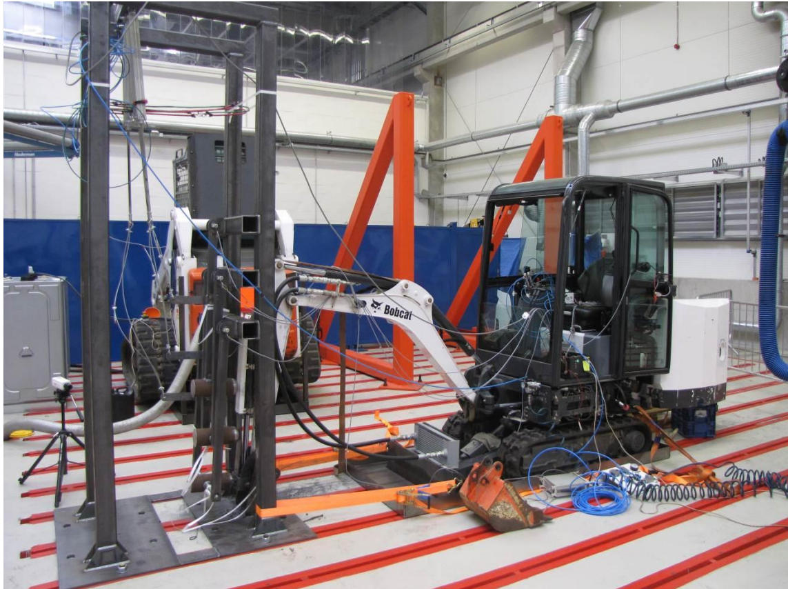
Obr. 21: Akcelerovaný laboratorní test životnosti
