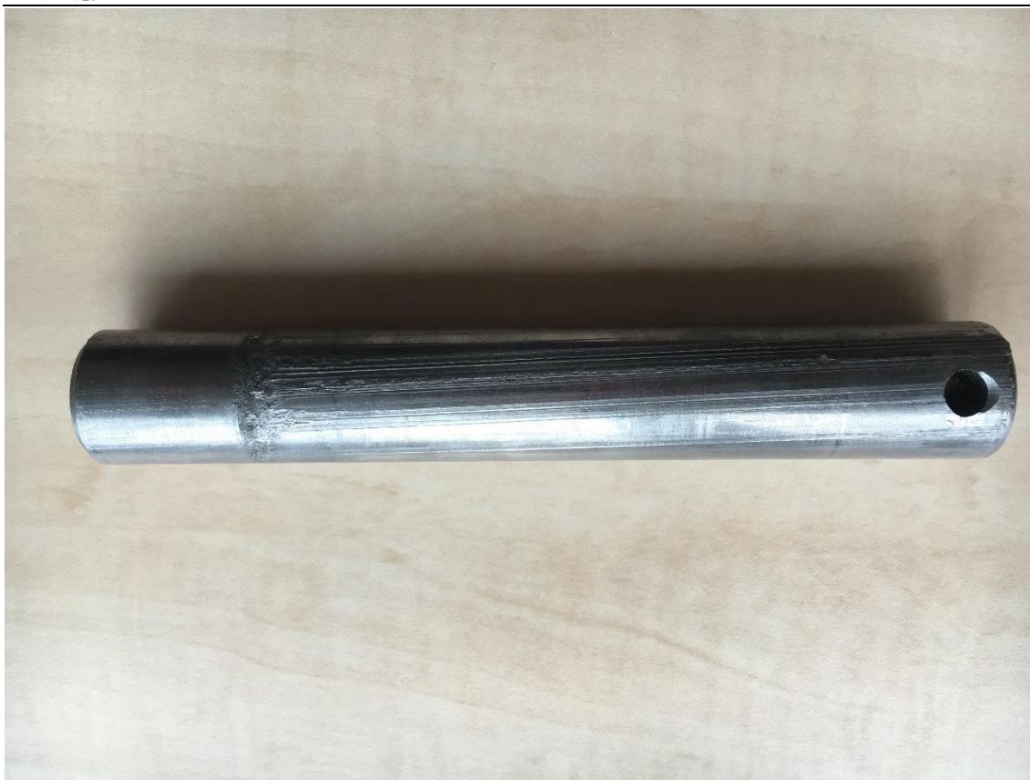
Obr. 34: Zátěžový test v provozu – poškozený spojovací čep - detail
