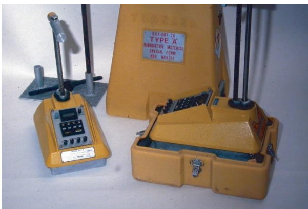
Obr. 5: Radiometrická soustava Troxler model 3411 [6]
