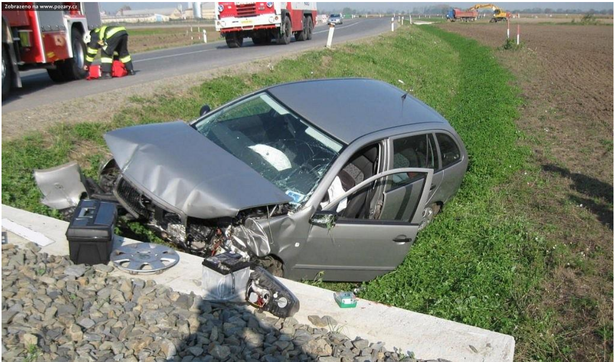
Obr. [23] Osobní automobil po nárazu do čela samostatného sjezdu
