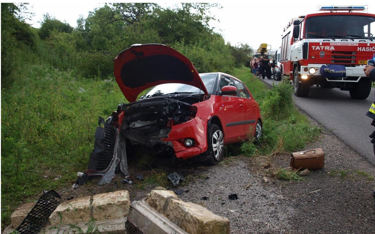
Obr. [39] Automobil Škoda Fabia II. generace po nárazu do čela samostatného sjezdu
