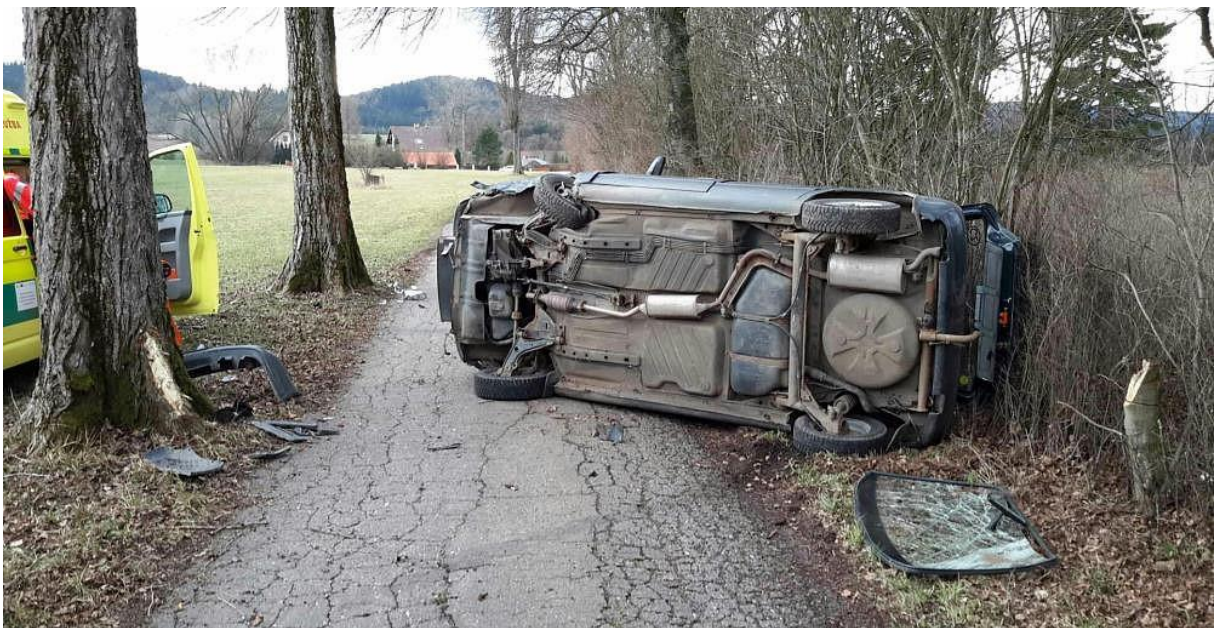
Obr. [14] Deformace vozidla po nárazu do stromu malou částí přídě („škrtnutí“)
