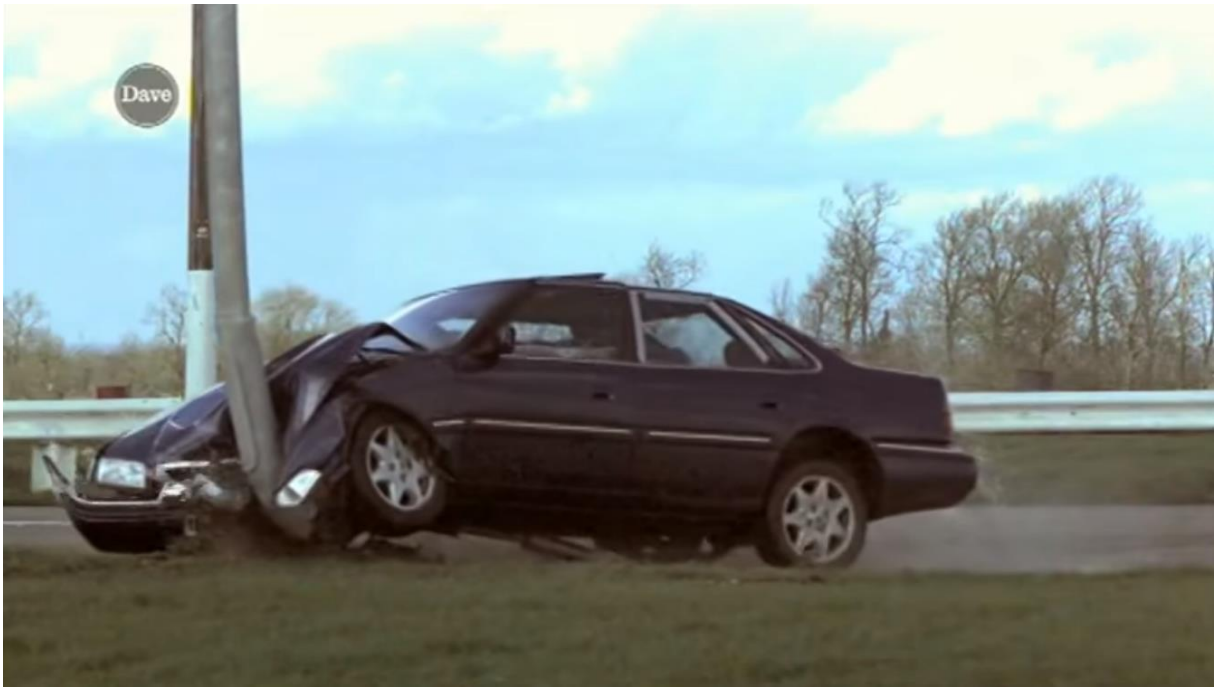
Obr. [19] Náraz vozidla do sloupu veřejného osvětlení, nedeformovatelný
