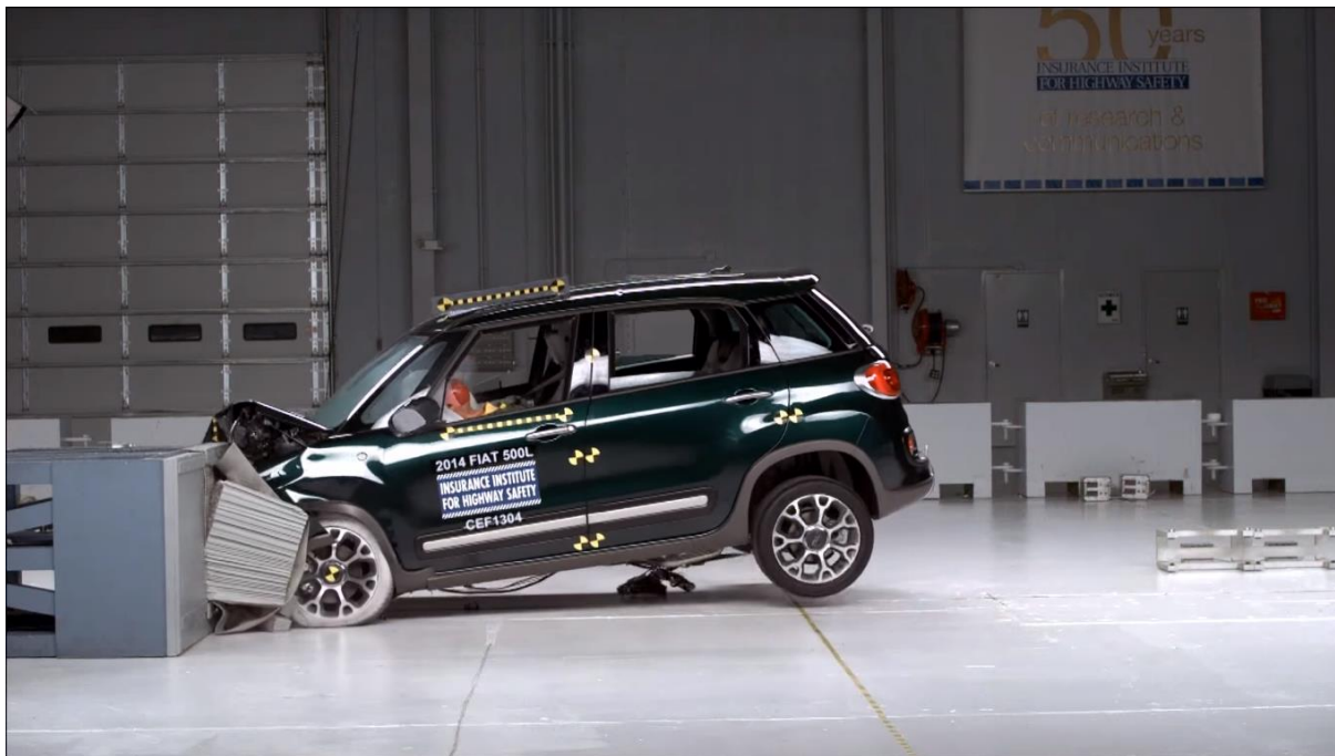
Obr. [2] Čelní náraz vozidla Fiat 500L do deformovatelné bariéry se 40 % přesahem
