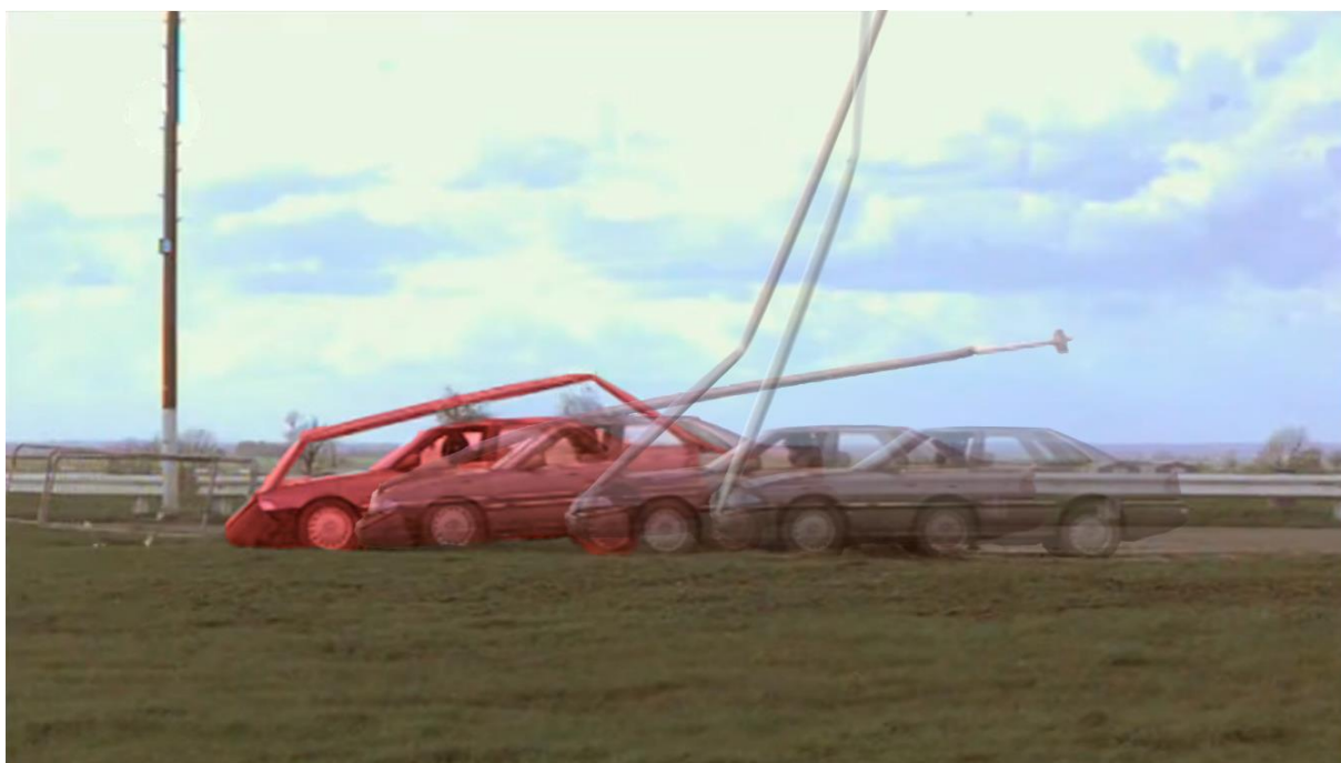
Obr. [18] Náraz vozidla na sloup pouličního osvětlení, deformovatelný
