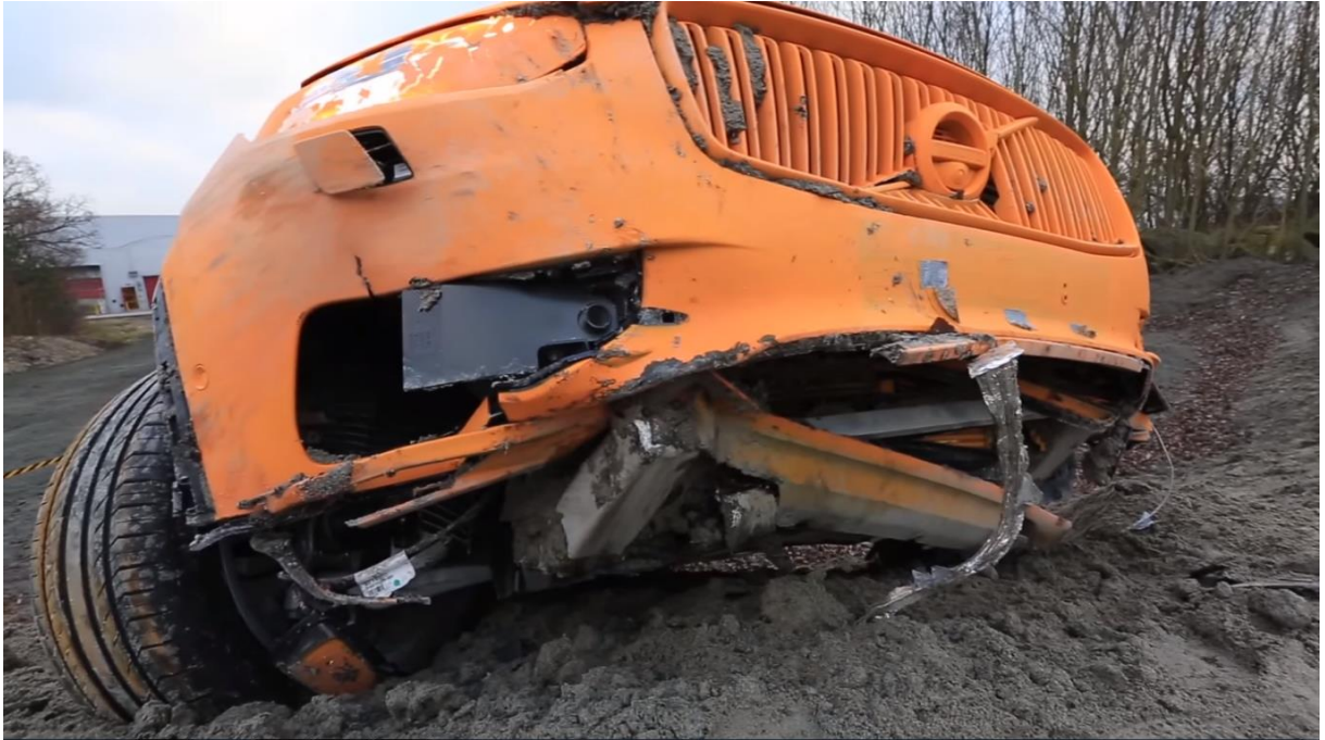
Obr. [28] Deformace přední části vozidla Volvo XC90 po nárazu do šikmého čela
