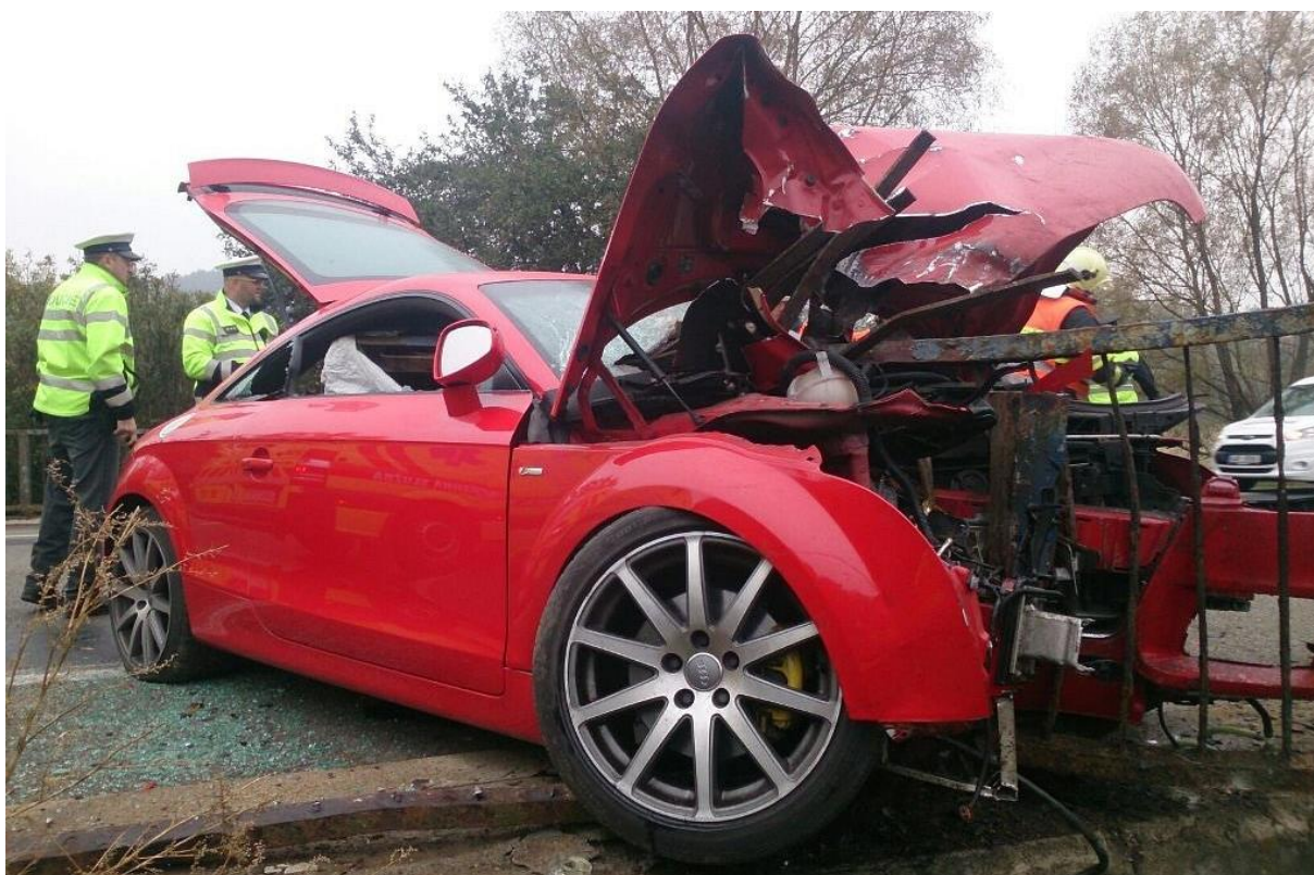
Obr. [22] Střet vozidla se zábradlím, které proniklo do interiéru vozidla
