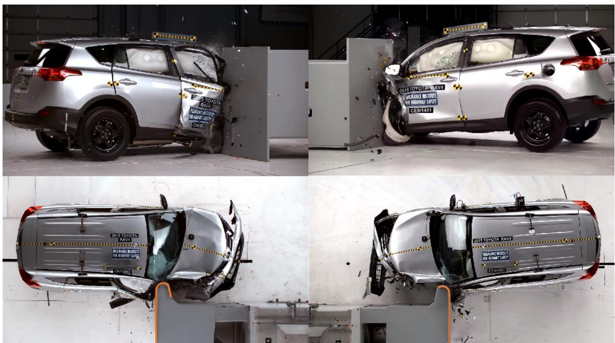
Obr. [6] Porovnání dvou identických nárazů s 25 % přesahem na obě strany, Toyota RAV4
