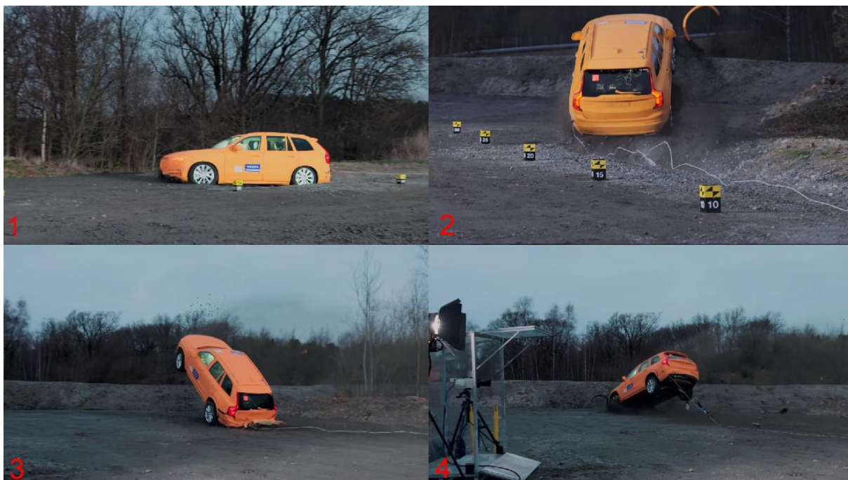
Obr. [27] Pohyb automobilu Volvo XC90 po nárazu na sešikmené čelo samostatného sjezdu
