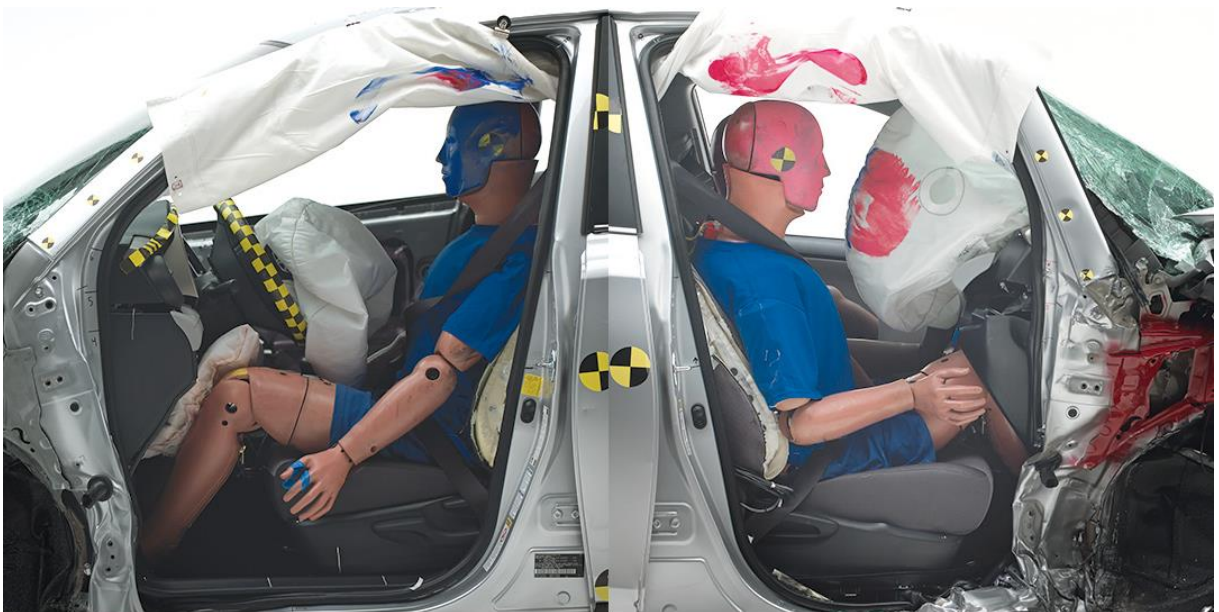
Obr. [8] Porovnání deformací na straně řidiče (vlevo) a na straně spolujezdce (vpravo) na automobilu Toyota RAV4 (modelový rok 2015)
