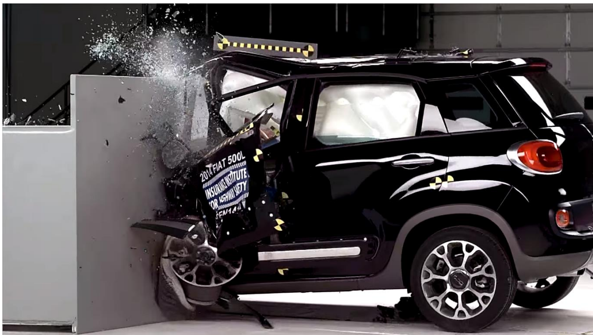
Obr. [4] Čelní náraz vozidla Fiat 500L do nedeformovatelné bariéry s 25 % přesahem
