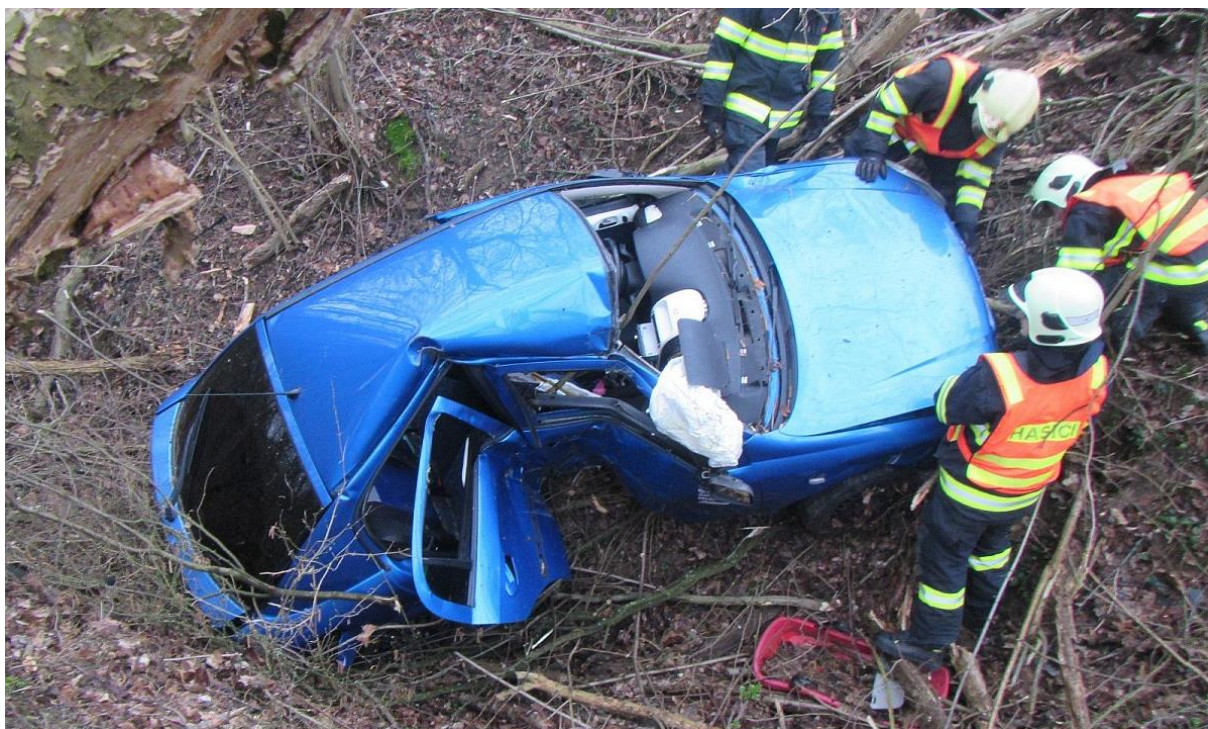
Obr.[15] Deformace boku vozidla po bočním nárazu na strom
