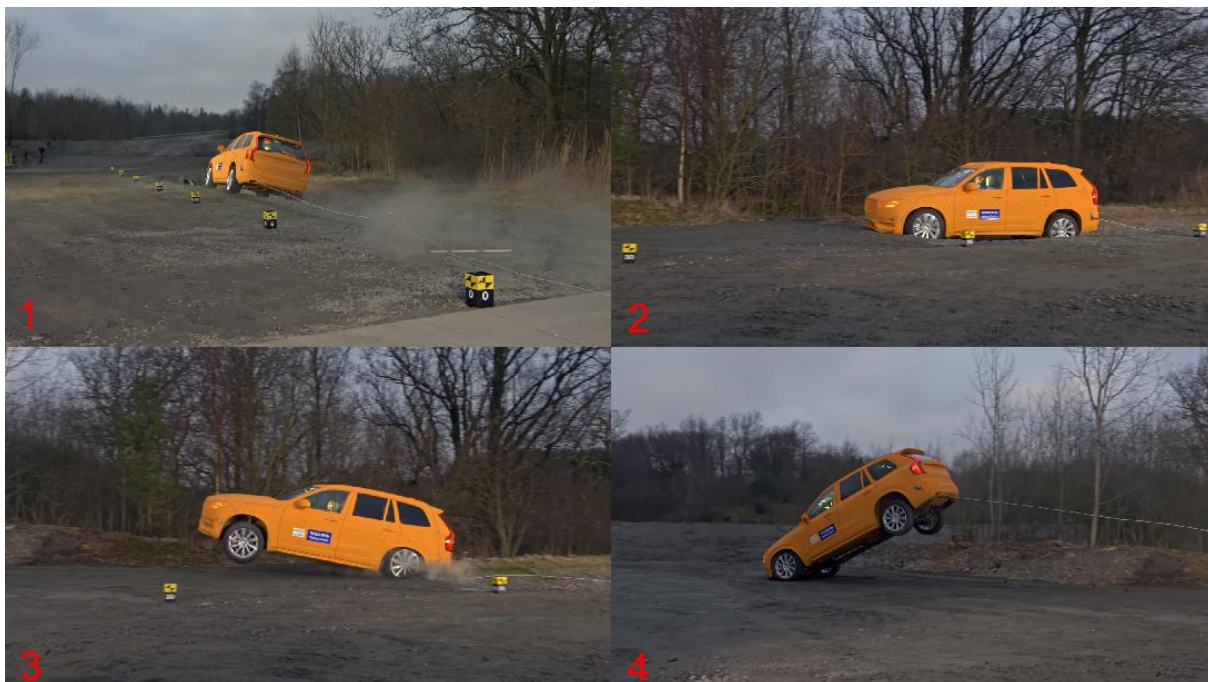
Obr. [26] Pohyb automobilu Volvo XC90 po nárazu na sešikmené čelo samostatného sjezdu
