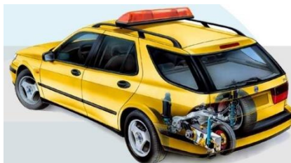
Obrázek 5: SAAB 9-5 Friction Tester [Zdroj: www.sarsys.se ]
