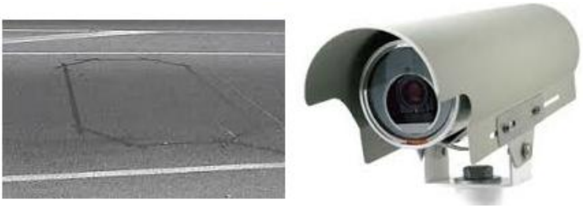
Obr. 5: Indukční smyčky vs videodetekce
