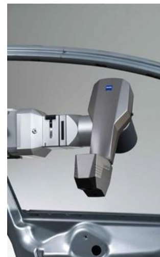
Obr. 25 Měření bezdotykovým snímacím systémem [7]
