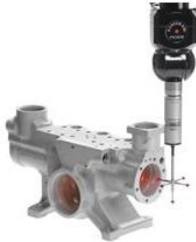
Obr. 14 Měření dotykovým snímacím systémem [6]
