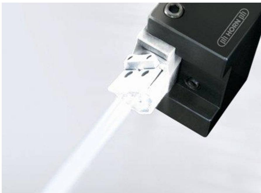
Obr. 8 Aplikace kryogenního chlazení [9]
