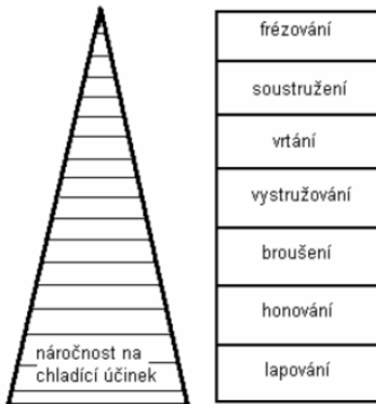
Obr. 6 Náročnost jednotlivých technologií na chladicí účinek [6]
