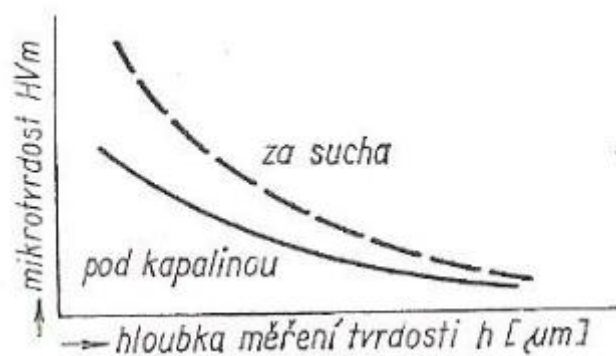
Obr. 12 Vliv řezné kapaliny na hloubku ztvrdnutí [2]
