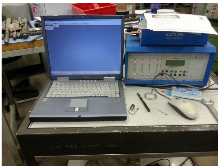
Obr. 28 Zesilovač a převodník signálu KISTLER 5019 s připojeným notebookem
