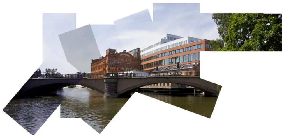
Obr. A.1: Rekonštrukcia scény z čiastkových obrázkov, ktoré boli zhotovené z rôznych uhlov a vzdialeností [19]
