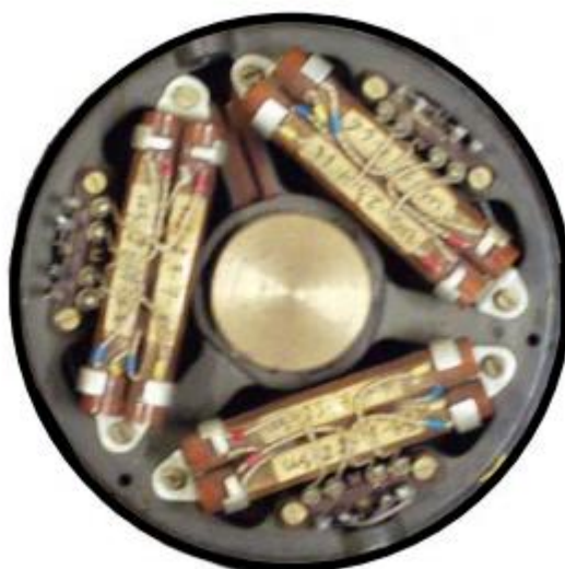
Obrázek 23. Magnetický snímač vodorovné složky zemského pole [1]
