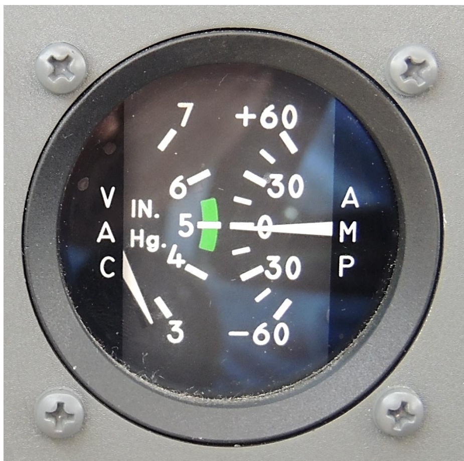
Obrázek 43. Indikace podtlakového systému a ampérmetr
