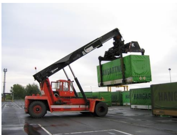
Obrázek 3: Překladač (reachstacker) s kleštinami při překládání výměnné nástavby [4]
