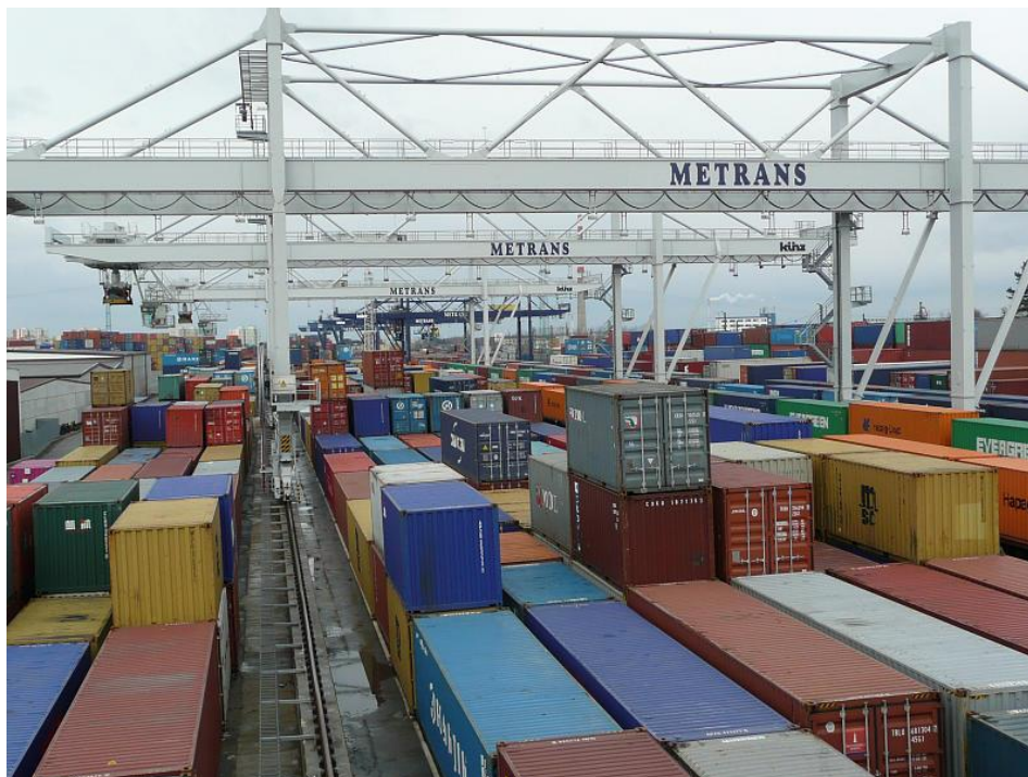
Obrázek 10: Portálové jeřáby v terminálu METRANS [18]
