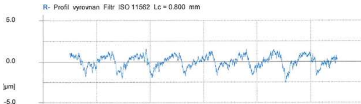
Obrázek 24 - Schodovitý povrch vytvořen vlivem vysokého přísuvu.
