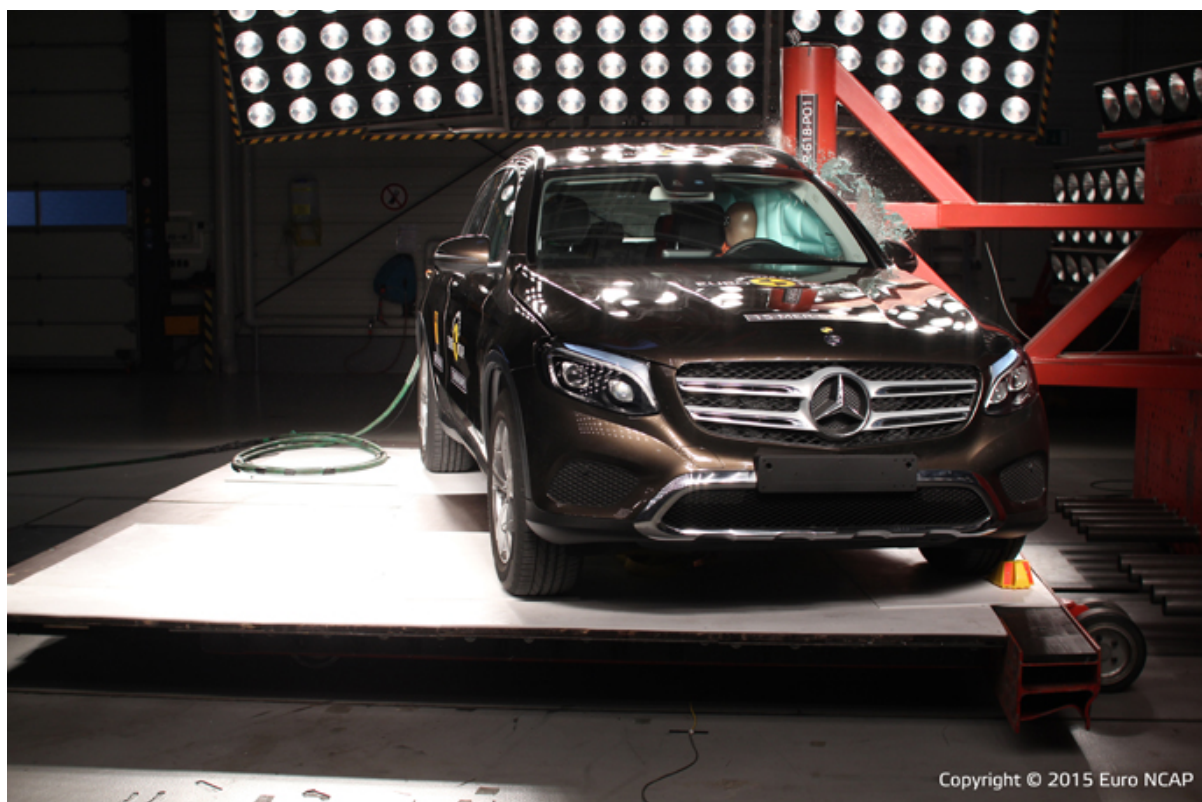
8 Test simulující boční náraz do stromu s vozidlem Mercedes Benz GLC - zdroj: http://euroncap.com
