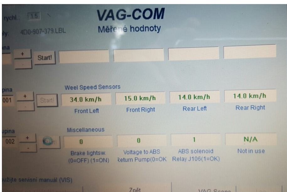
Obrázek 15 Rychlost otáčení jednotlivých kol při smyku
