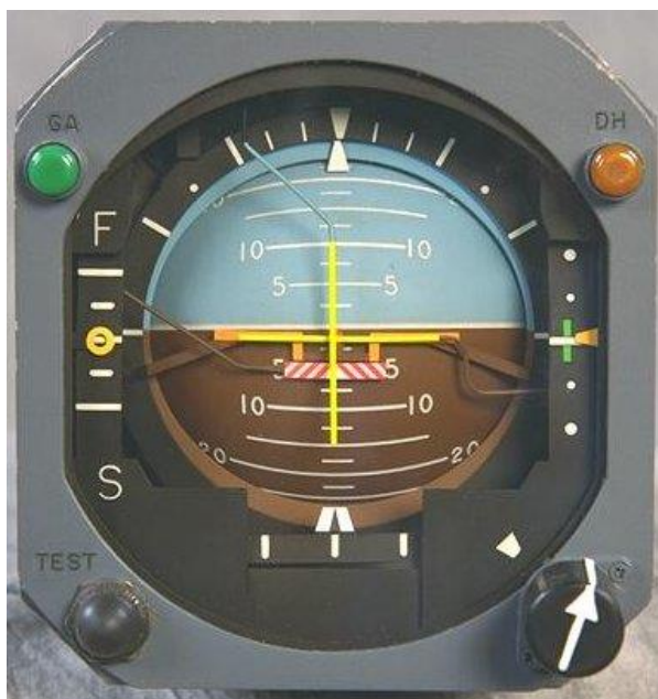
Obrázek 10: Umělý horizont (zdroj: www.cs.wikipedia.org )
