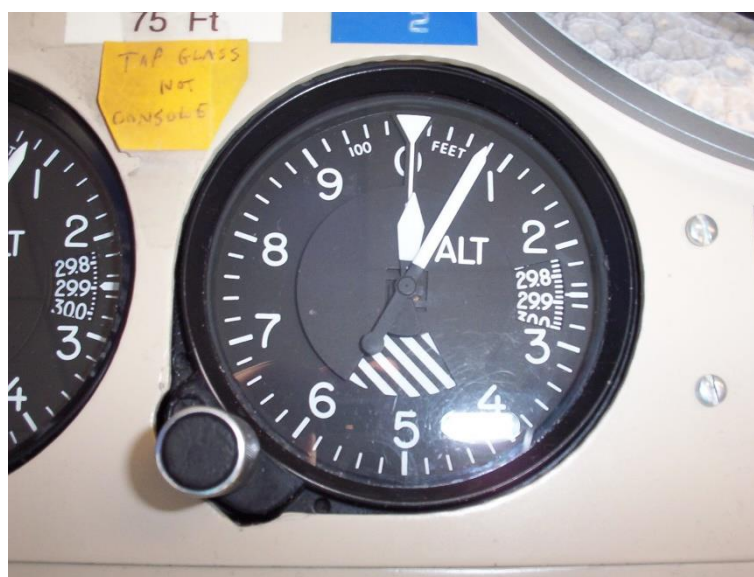
Obrázek 7: Ukazatel výškoměru (zdroj: www.cs.wikipedia.org )
