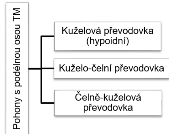
Obrázek 2.: Rozdělení konceptů pohonů s podélnou osou TM
