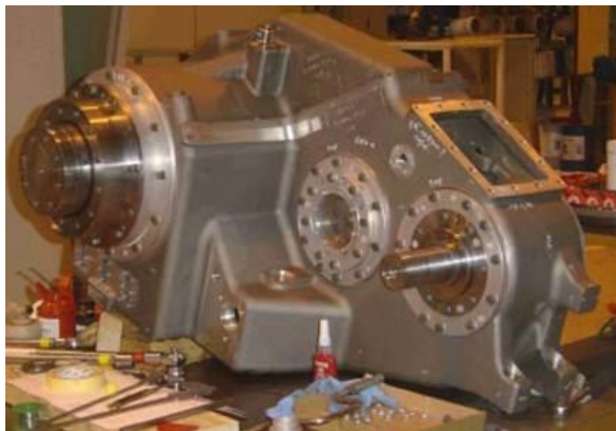
Obrázek 15.: Tříkolová převodovka vlaku AGV [3]
