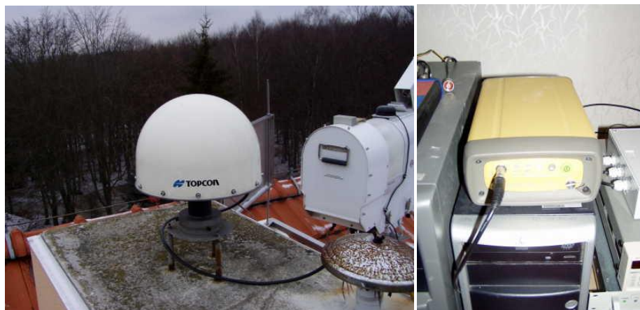
Obr. 4: GOPE vlevo anténa Topcon CR-G3 umístěná na bodě, vpravo přijímač Topcon NetG3
