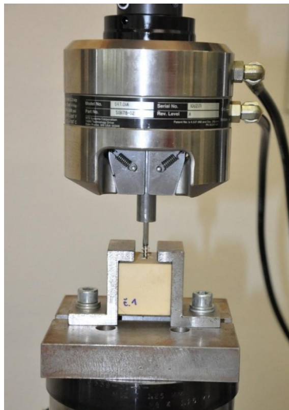
Obr. 21 – Vzorek č. 1 upnutý v testovacím systému MTS 858.2 připravený na experiment
