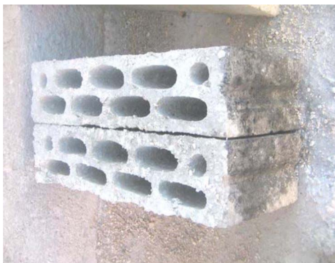
Obrázek 20 – Vyrobené vylehčené stavební bloky tloušťky 150 mm (Aukour 2009).
