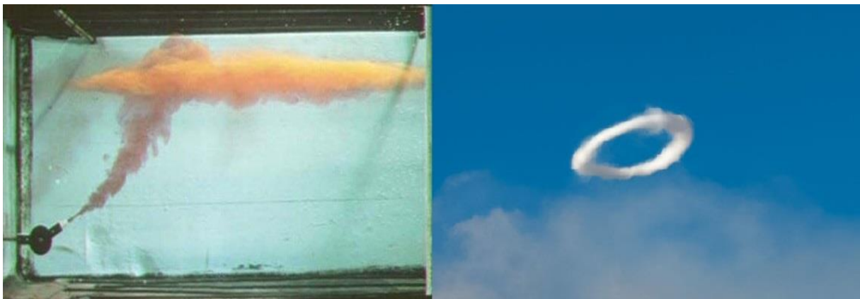
Obr. 2.10a,b Vlevo nadnášený (pozitivní) paprsek ( Buoyant Jet ) a vpravo přerušovaný nadnášený paprsek ( Buoyant Puff ).
