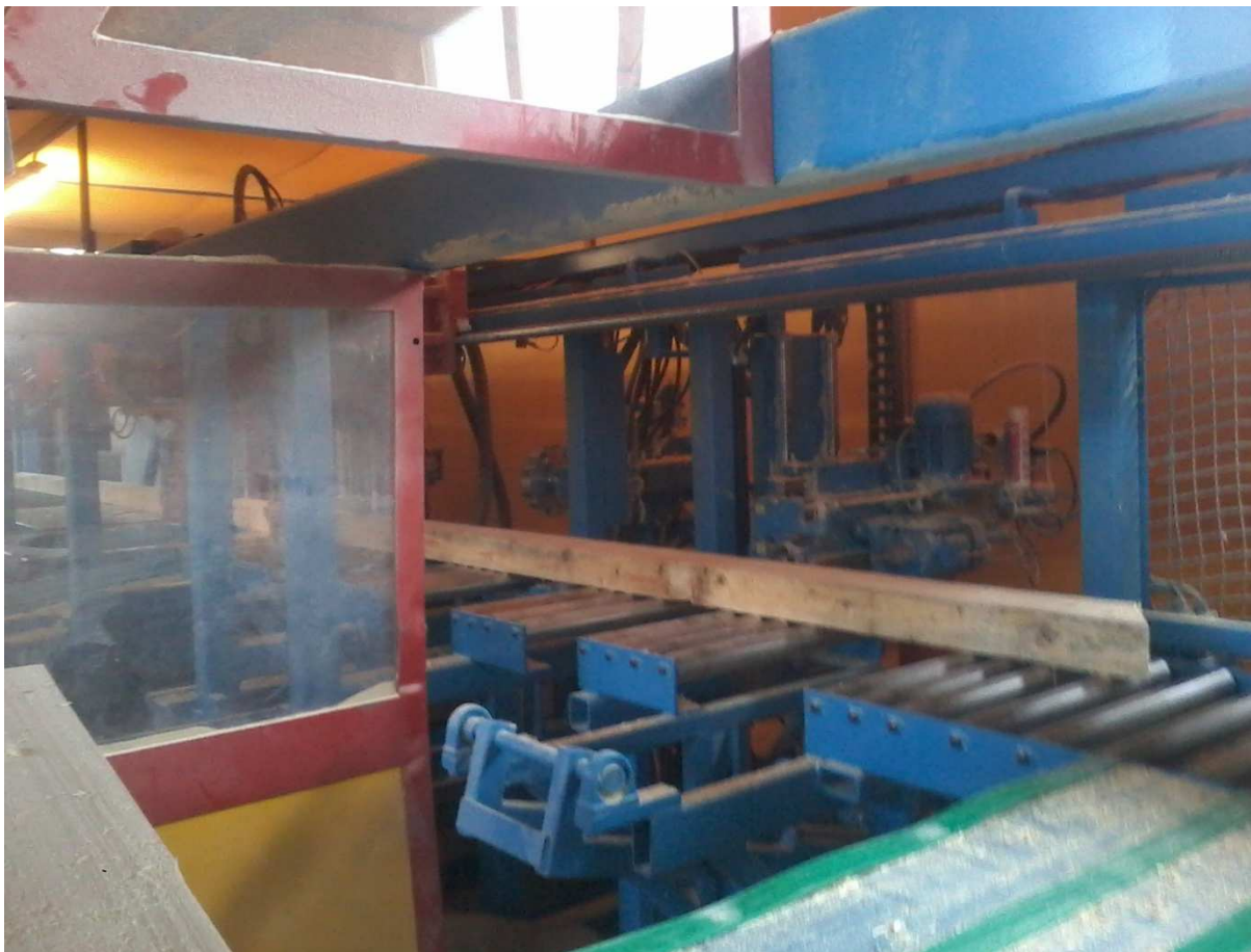
Obr. 27. – CNC obráběcí centrum – průběh obrábění profilu (DEKWOOD)
