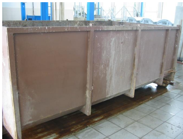
Obrázek 13: kontejner na skladování odpadu zachyceného lapákem štěrku
