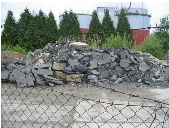
Obrázek 10: skladování stavebního materiálu Firma CHVaK a. s. skladuje tento materiál v areálu svého sídla. Jedná se převážně o rozřezané asfaltové pásy a stavební materiál z rozbitých dopravních cest. Tento materiál je zpětně využíván k výstavbě příjezdových cest na území dočasného staveniště. Zdroj: autor
