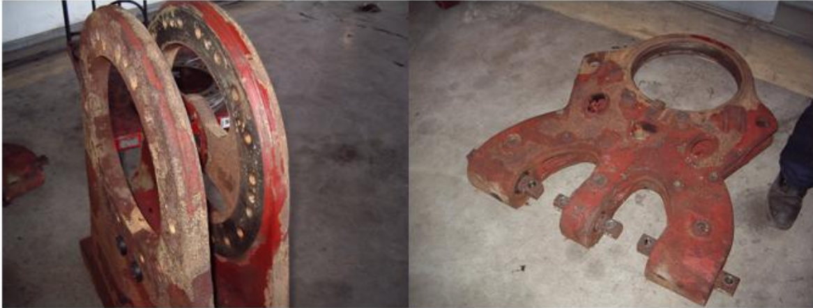
Obr. 18 – Vlevo pevná část spojení, vpravo část upevněná na silentblocích
