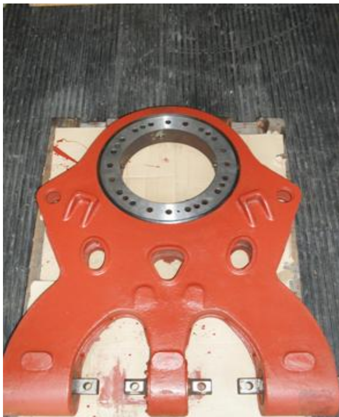
Obr. 21 – Část segmentu kloubu po renovaci, která je připravena k expedici k zákazníkovi
