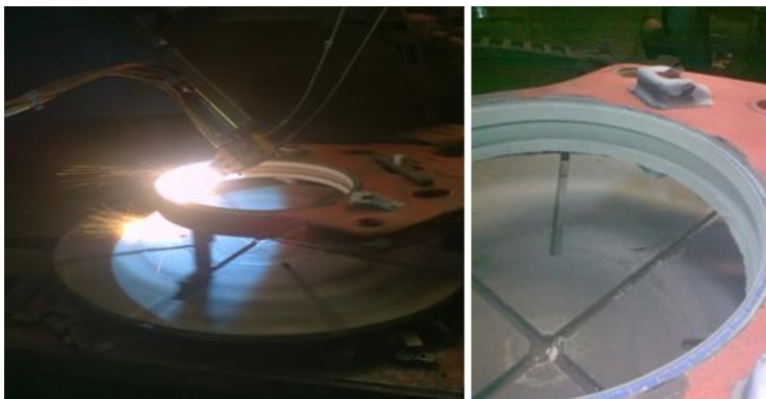
Obr. 20 – Realizace nástříku segmentu kloubu vlevo a vpravo hotový nástřík
