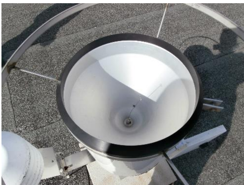
Obr. 23 Pohled do srážkoměru včetně korunky
