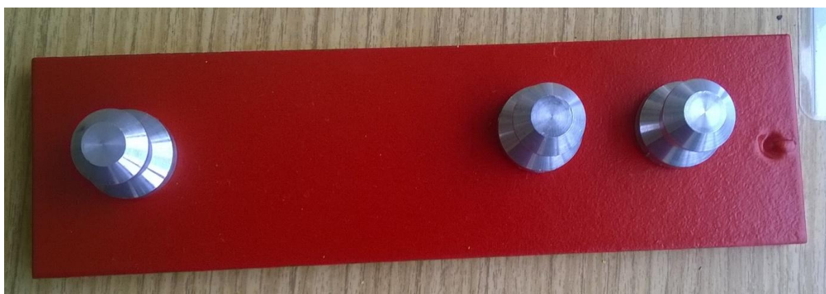
Obr. 3.5.3 Skúšobná vzorka s terčmi pripravené na prevedenie skúšky od trhom.
