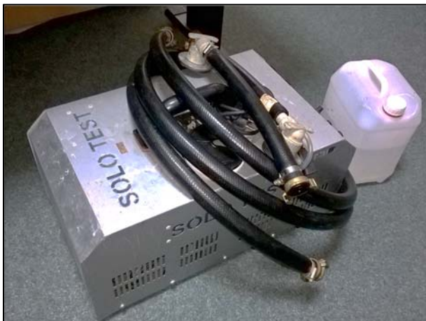
Obr. 10: Zařízení SOLOTEST vytvářející dým (foto autor)
