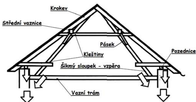
Obr. 13: Ležatá stolice (Převzato z http://uvp3d.cz/dum/wp-content/uploads/2014/07/UvP_STAVO_STA60_026_podep%C5%99en%C3%AD-le%C5%BEat%C3%A9-stolice.png )
