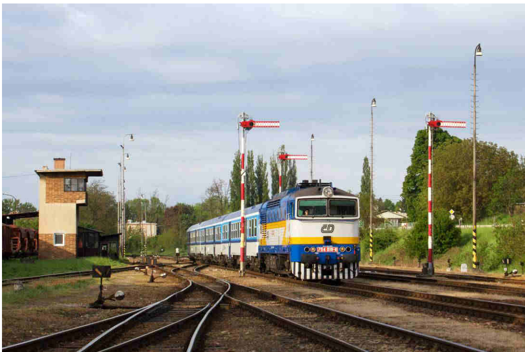
Obr.18: Lokomotiva 754.019 mĳí odjezdov navěstidla stanice Kyjov
