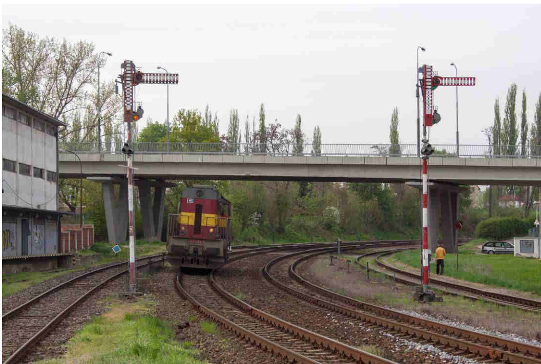
Obr. A3: Pohled zepředu na mechanická návěstidla.
