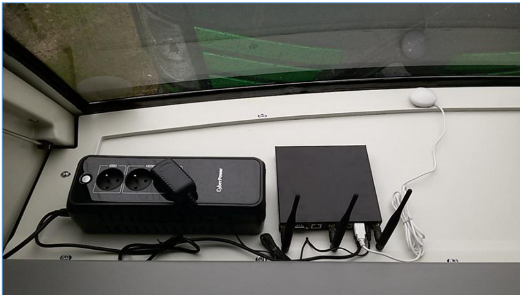
Obrázek 12: Průmyslový počítač, GPS modul a záložní zdroj kryjící dočasné výpadky proudu na lokomotivě Vectron dopravce ELL [Zdroj: foto autor]
