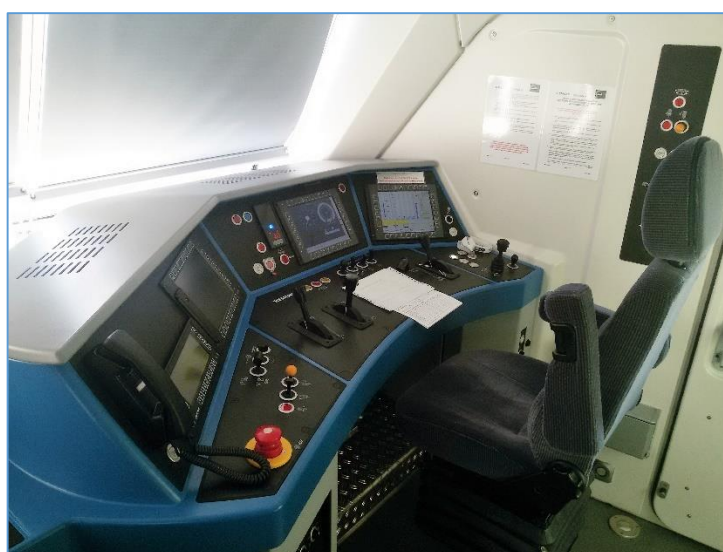
Obrázek 3: Stanoviště strojvedoucího lokomotivy Siemens Vectron společnosti ELL [Zdroj: Foto autora]
