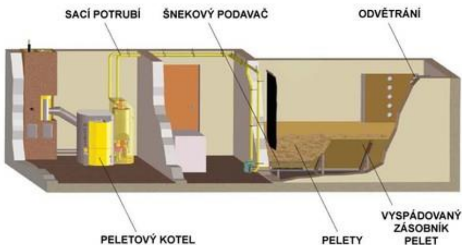
obr. 22 - Peletová kotelna se šnekovým dopravníkem (6)
