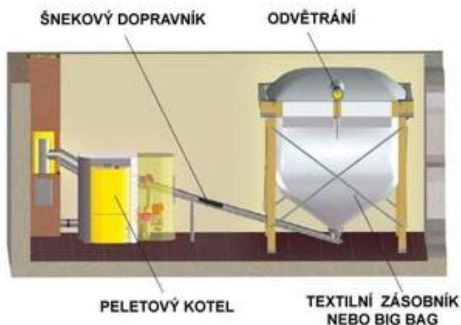
obr. 23 - Peletová kotelna s textilním zásobníkem (6)
