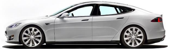
Obr. 6 – Tesla Model S. C_x=0,24 . Rok 2014 [3]
