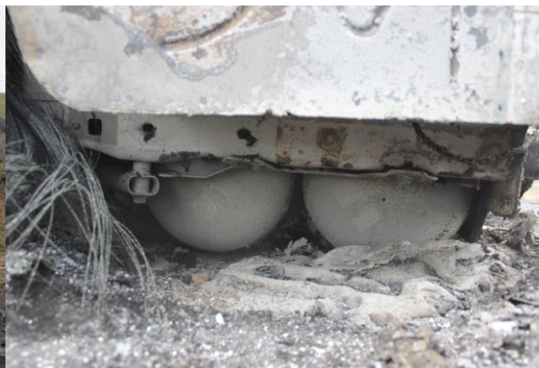
Obrázek č. 6: Tlakové lahve na CNG ve spodní části vozu
