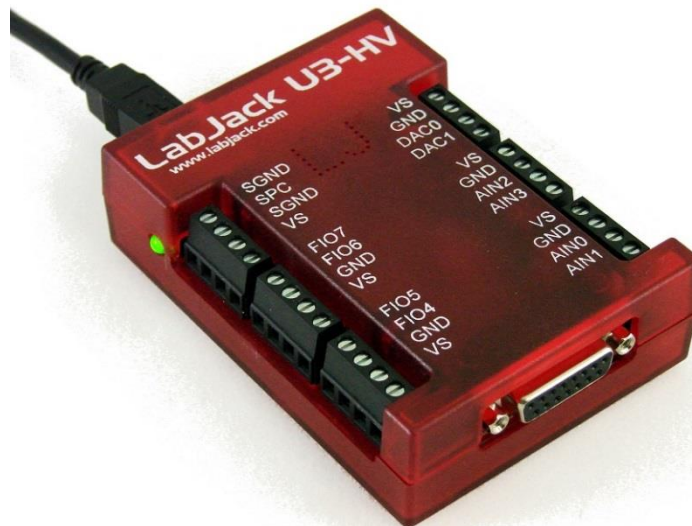
Obrázek 28. Měřicí karta LabJack U3-HV
