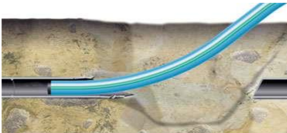
Obr. 41 – Technologie obnovy prostým vyvločkováním potrubí; prostý relining)
