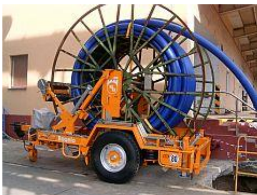
Obr. 37 – Bubny s flexibilní délkou potrubí/kabelů
