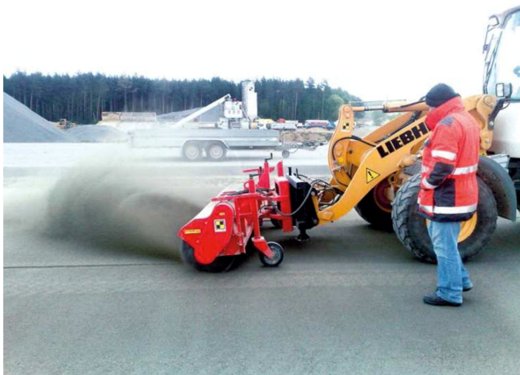
Obrázek 7 - Použití speciálního vymetacího kartáče [8]
