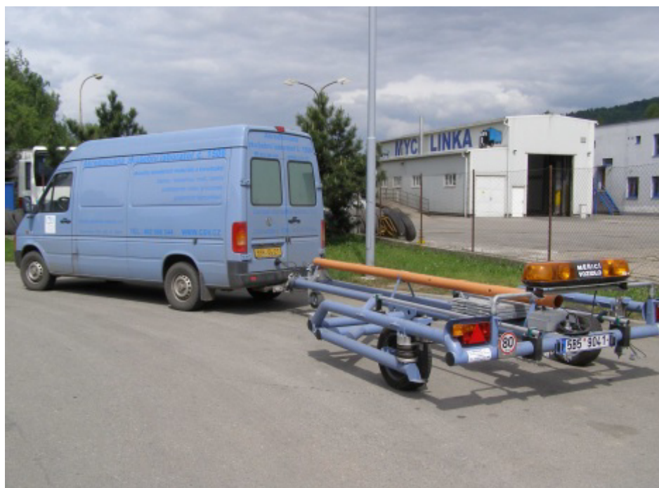
Obrázek 2 - Souprava pro měření hluku metodou SPX [15]
