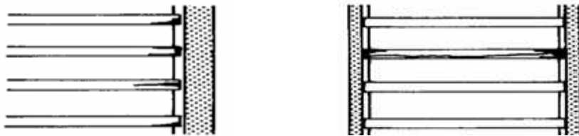
Obr. 11- a) Poškození zhlaví trámu (vlevo), b) Poškození trámu v celém rozpětí (vpravo) [3]
