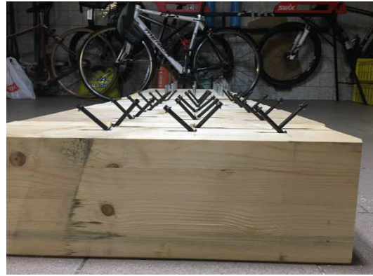
Obr. 32- a) Montáž šroubů LUX 8x140 (vlevo, )b) Montáž vrtů VB-48-7,5x165 (vpravo)
