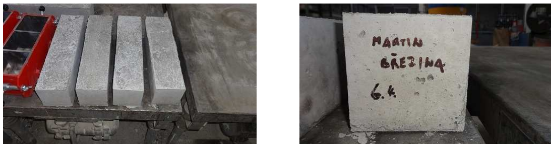
Obr. 36- a) Odbedněná zkušební tělesa (vlevo), b) Detail odbedněného tělesa (vpravo)
