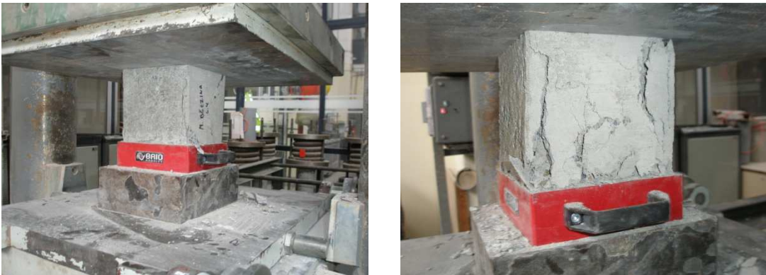
Obr. 37- a) Zkouška betonu v tlaku (vlevo), b) Vznik trhlin (vpravo)
