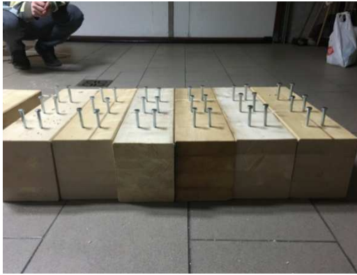
Obr. 32- a) Montáž šroubů LUX 8x140 (vlevo, )b) Montáž vrtů VB-48-7,5x165 (vpravo)
