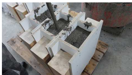
Obr. 34- a) Suroviny pro výrobu betonu (vlevo), b) Hutnění pomocí ponorného vibrátoru (vpravo)
