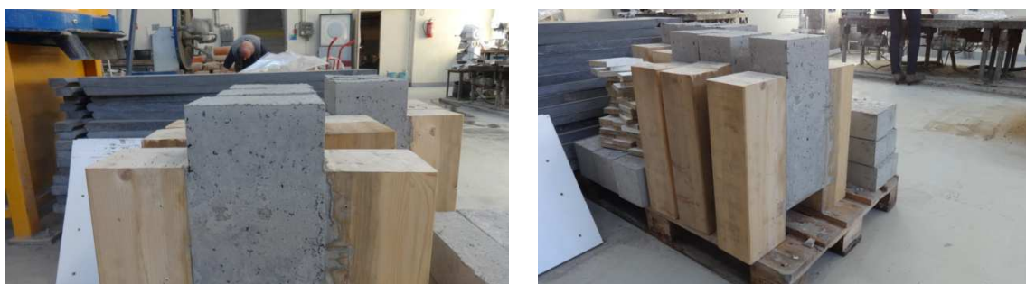
Obr. 37- a), b) Odbedněné dřevobetonové vzorky
