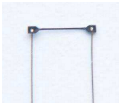
Obrázek 20: Polovodičový tenzometr Zdroj:[5]
