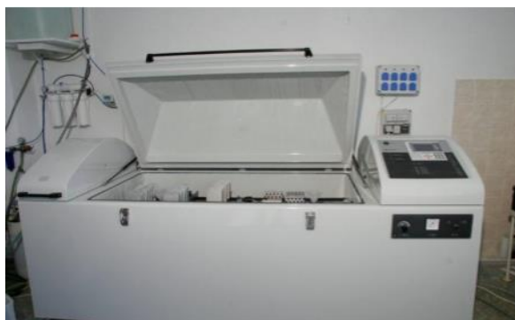
Obr. 24 – Zkušební komora pro zkoušku v NSS [41]
