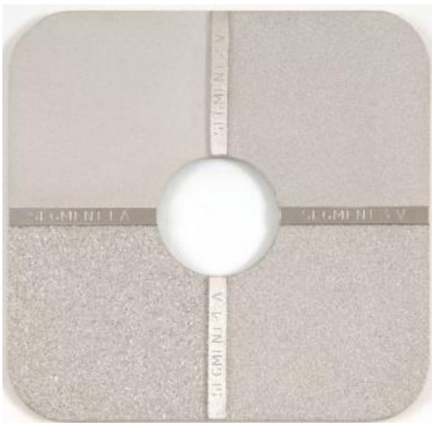
Obr. 11 - ISO komparátor v souladu s ČSN EN ISO 8503 [28]
