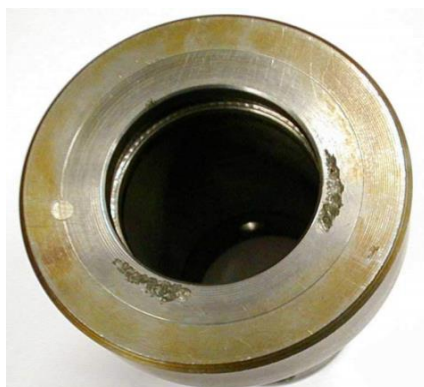
Obr. 6 – Štěrbínová koroze korozivzdorné oceli pod těsněním [19]
